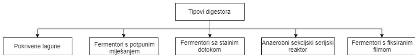
Slika 3.6. Tipovi digestora
