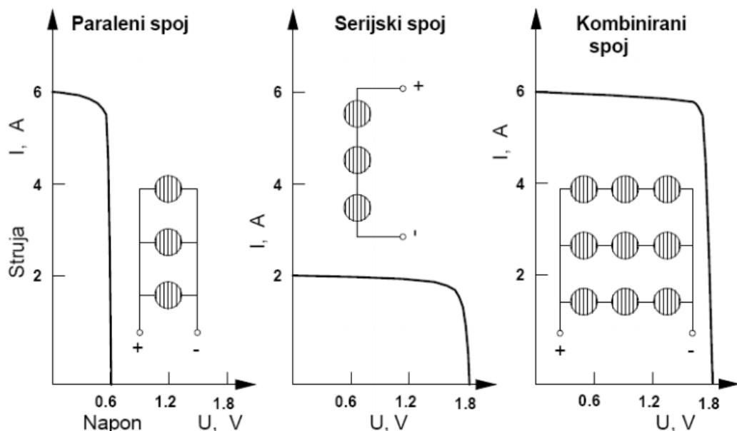
Slika 2.1. I-U karakteristike paralelnog, serijskog i kombiniranog spoja fotonaponskih čelija [1]
