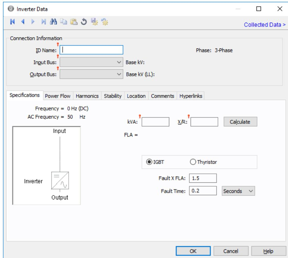
Slika 3.8. Parametri izmjenjivača – kartica specifikacija [5]
