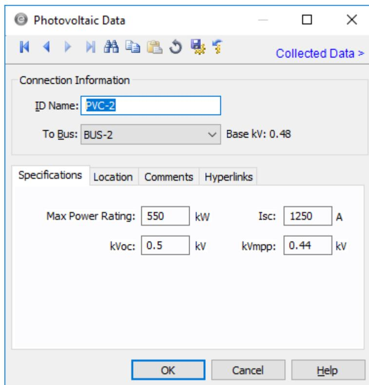
*Slika 3.7. Parametri fotonaponskog modula PVC-2 [5]*
