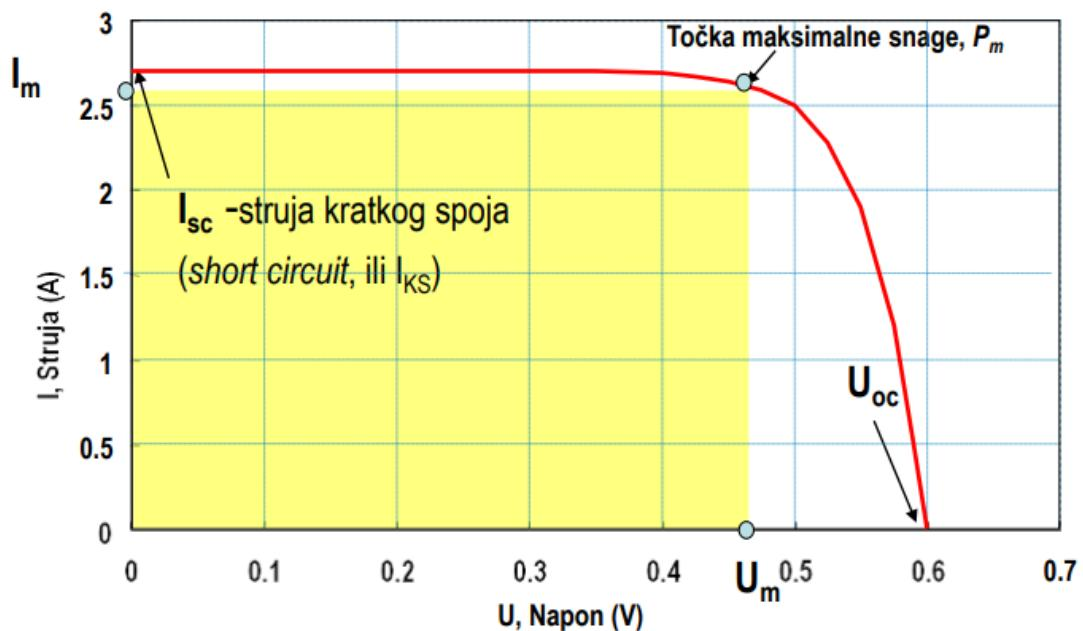
Slika 2.2.  $I$ - $U$  karakteristika fotonaponskog modula [2]
