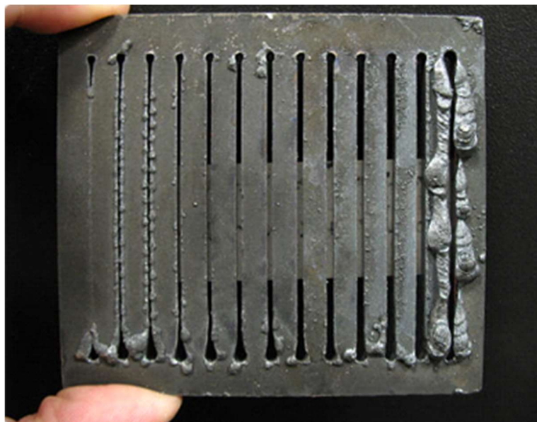
Slika 1.1. Rezovi dobiveni različitim visinama elektrode [2]
