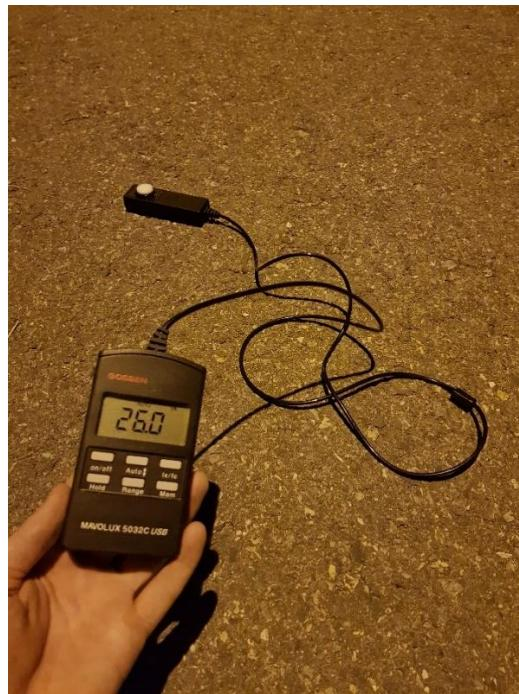
Slika 4.23. Mjerenje osvjetljenja.
