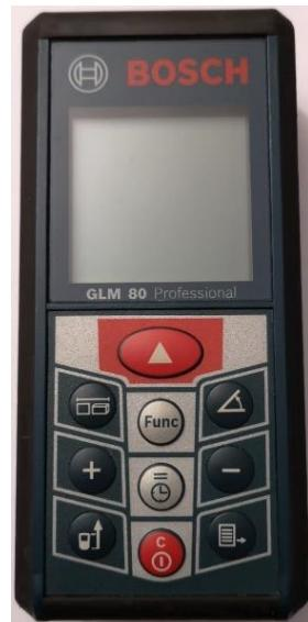
Slika 4.7. Instrument Bosch GLM 80.
