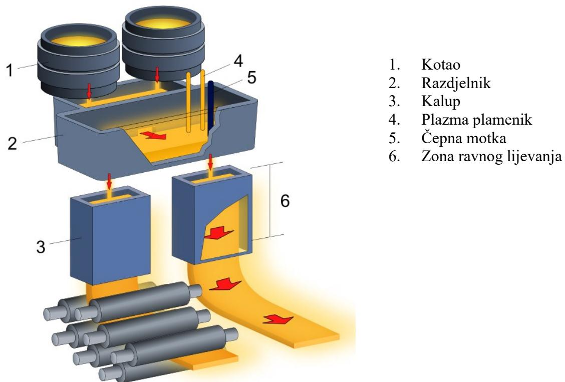
**Sl. 2.6. Kontinuirano lijevanje (zakriviljeni, višekalupna izvedba).**
