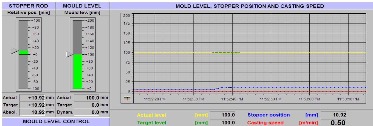
**Sl. 3.24.** Odziv simulacije modela karakteristike čepne motke u stacionarnom stanju za testni slučaj 2.
