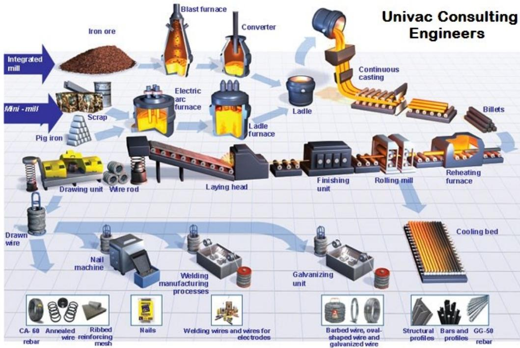
**Sl. 2.15.** Pogon za proizvodnju i obradu čelika.
