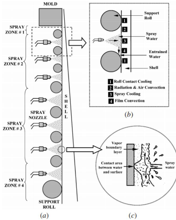
**Sl. 2.11. Sekundarna zona hlađenja:** (a) prikaz potpornih valjaka i mlaznica za hlađenje, (b) prikaz jedne zone sekundarnog hlađenja, (c) detalj dodirne točke hlađenja između čelika i smjese zrak-voda [6].
