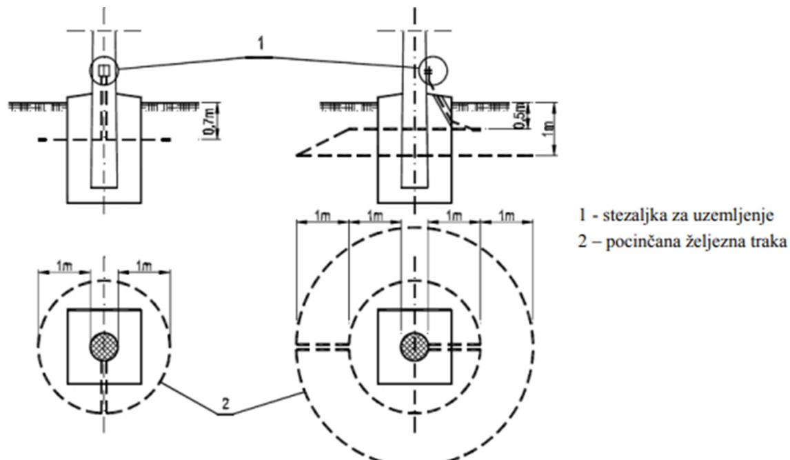
Slika 2.1. Prstenasti uzemljivač distribucijskog dalekovodnog stupa [8]
