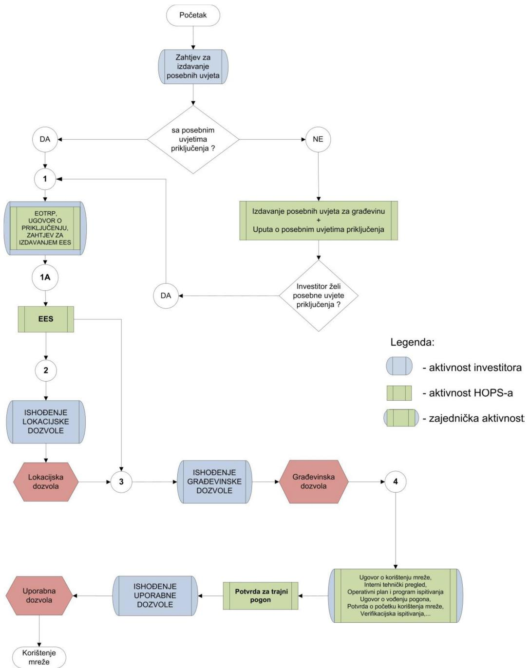
Slika 2.4. Općeniti blok dijagram kompletog postupka za ishodenje dozvola utvrđenim mjerodavnim propisima za građevinu sa priključenjem investitora na prijenosnu mrežu [9]
