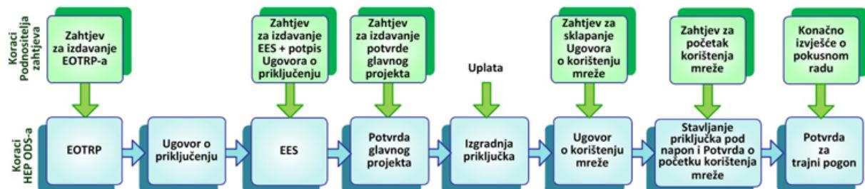
Slika 2.3. Postupak priključenja postrojenja putem EOTRP-a [9]
