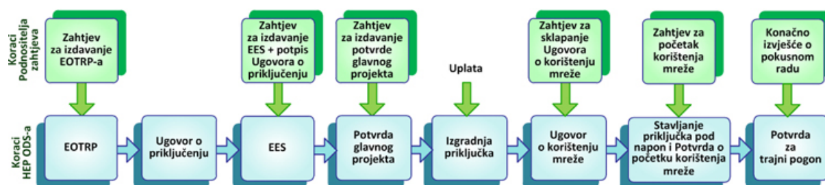
Slika 2.3. Postupak priključenja postrojenja putem EOTRP-a [9]
