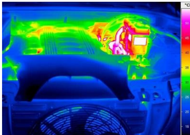
Sl.5.5.1. Termogram motora automobila [22]
