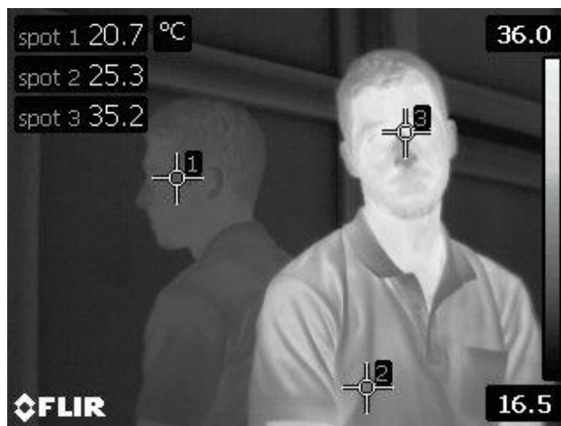
Sl.3.2. Primjer termografskog zapisa osobe i odraza u staklu
