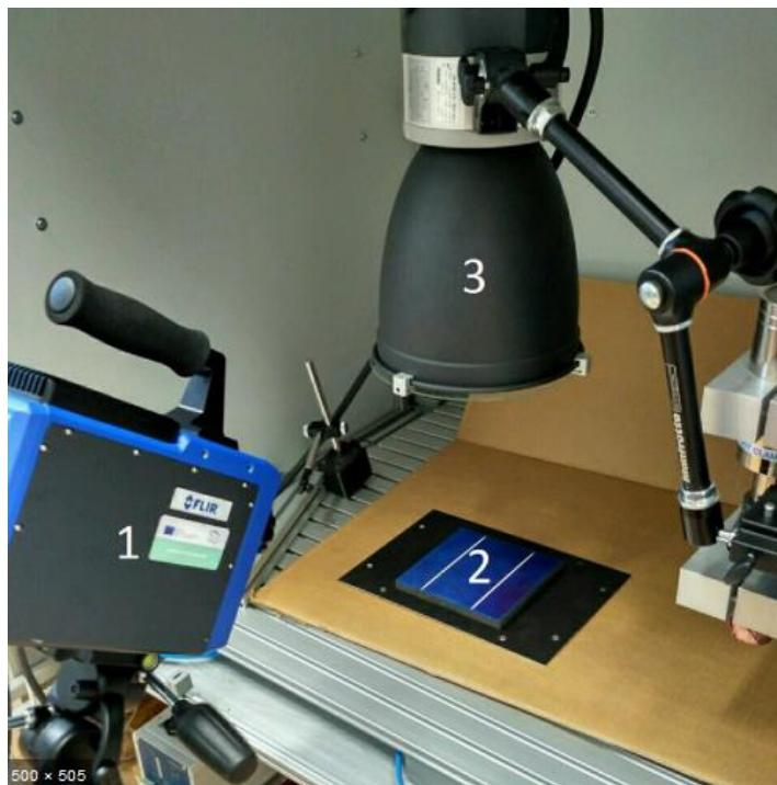
**Sl.5.2.1.** Eksperiment aktivne termografije na solarnoj čeliji [17]
