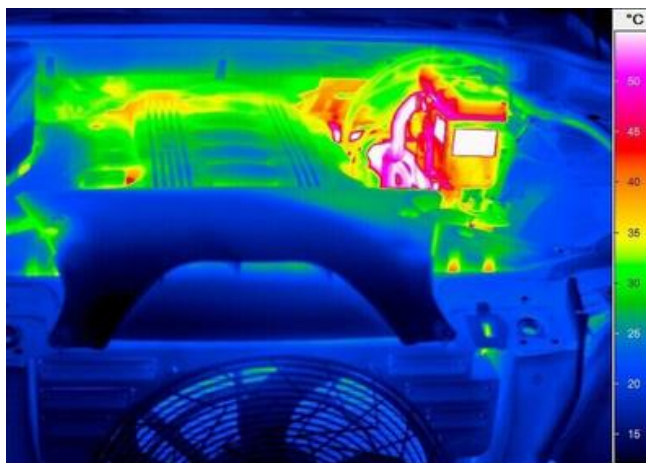
Sl.5.5.1. Termogram motora automobila [22]
