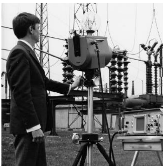
Sl.2.2. Provedba termografske analize iz 1969. godine [3]
