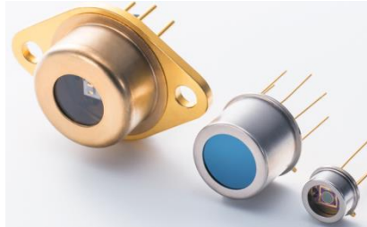
SI.2.3. Različiti infracrveni detektori (s lijeve strane: InSb, InAsSb, InGaAs ) [5]
