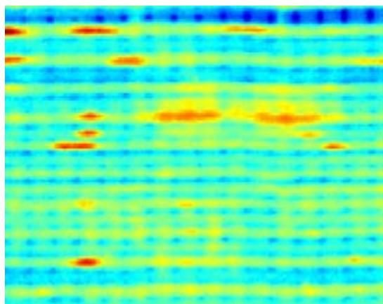
**Sl.5.4.2.** Termogram kompozitnog materijala sa slabo vidljivim oštećenjem [11]
