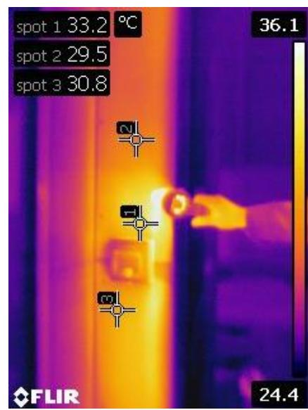
**Sl.6.2.3.** Iznalaženje konstruktivnih elemenata gips-kartonskih ploča
