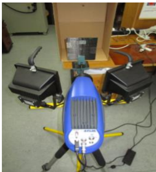
Sl.3.2.1. Eksperiment aktivne termografije [11]
