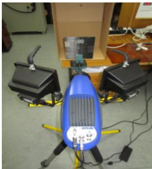
Sl.3.2.1. Eksperiment aktivne termografije [11]
