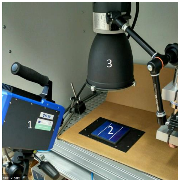
SI.5.2.1. Eksperiment aktivne termografije na solarnoj ćeliji [17]
