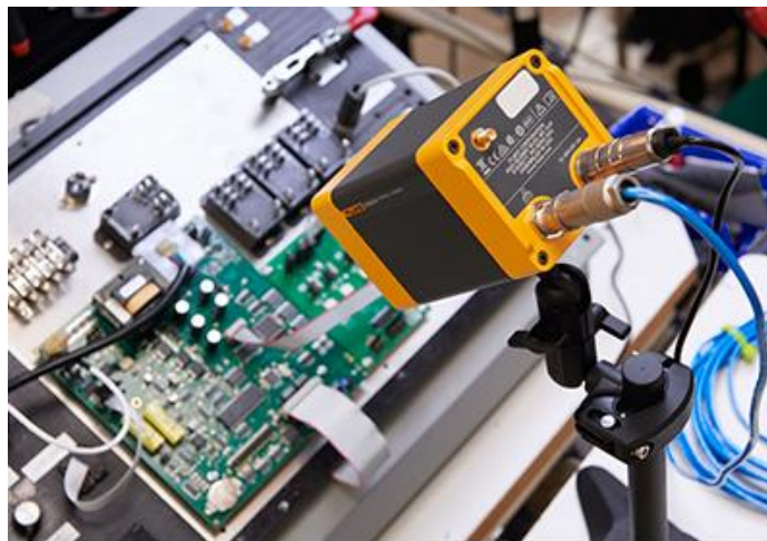
Sl.6.1. Fluke RSE300 infracrvena kamera visoke rezolucije [26]
