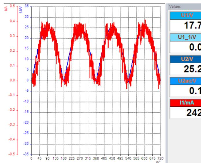
**Slika 3.8.4.** Valni oblici ulazne struje i napona
