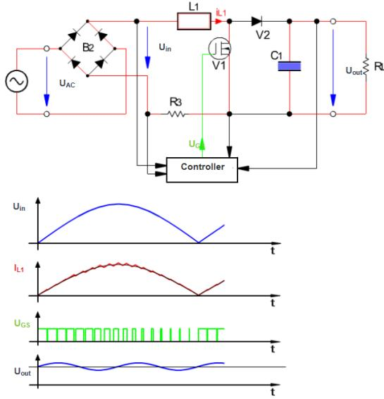
**Slika 4.2.4.** Shema s PFC-om i pripadajući valni oblici
