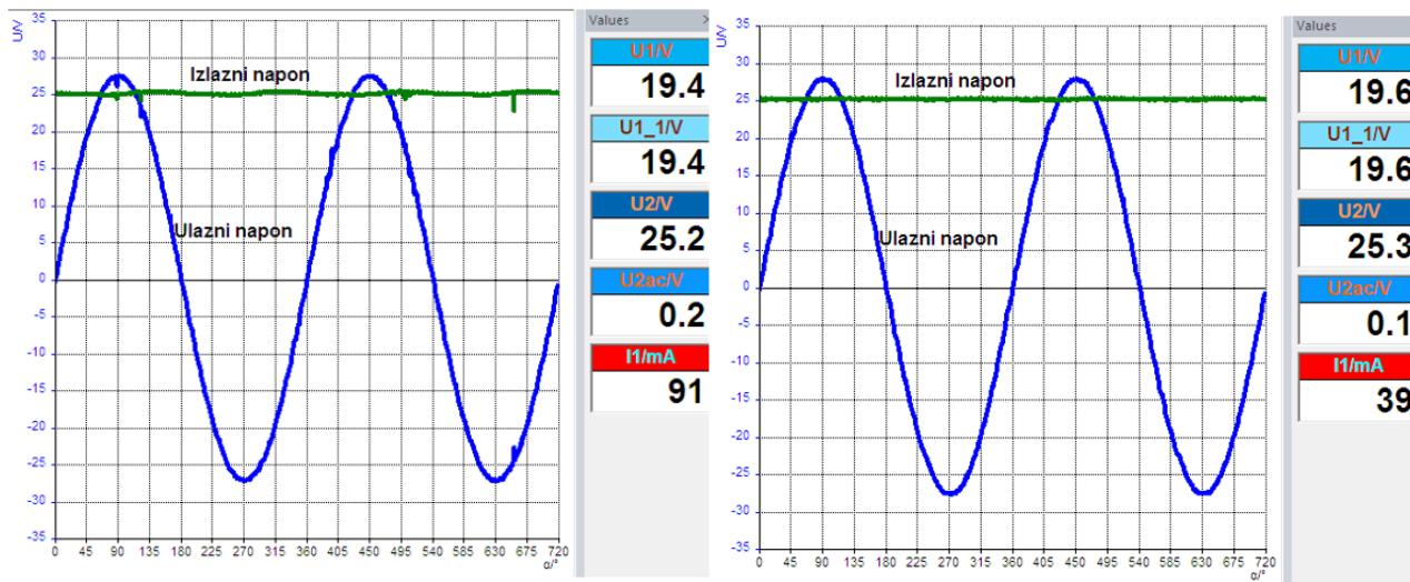
**Slika 3.6.3.** Valni oblici ulaznog i izlaznog napona s PFC-om s 80% ulazne amplitude
