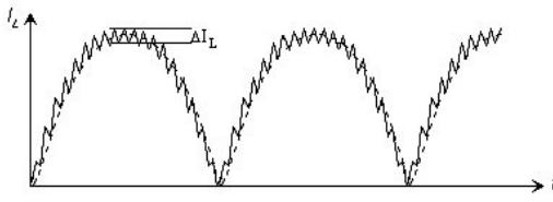
**Slika 4.2.3.** Uvećani valni oblik struje  $i_{L1}$
