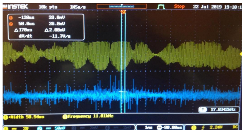
Slika 2.1: prikaz izlaznog signala prije i poslije operacijskog pojačala
