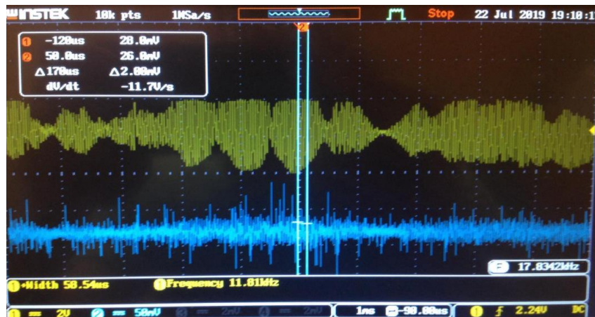
Slika 2.1: prikaz izlaznog signala prije i poslije operacijskog pojačala
