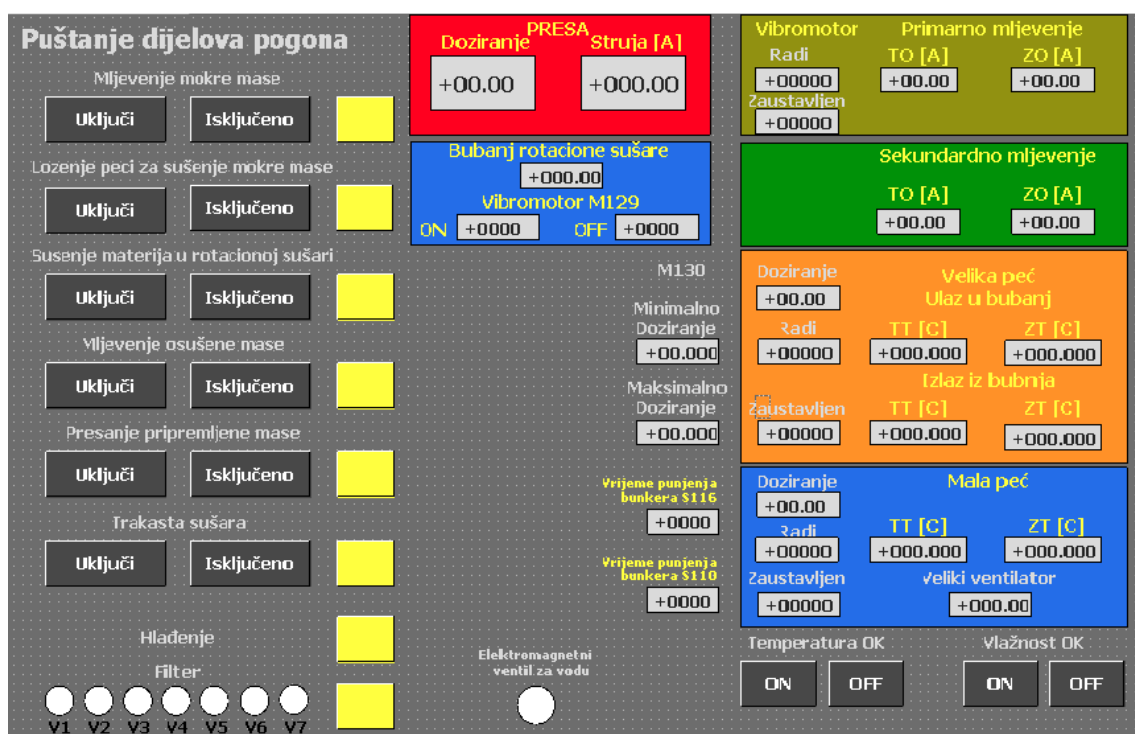
Slika 5.41. Osnovni ekran sučelja automatizacije.
