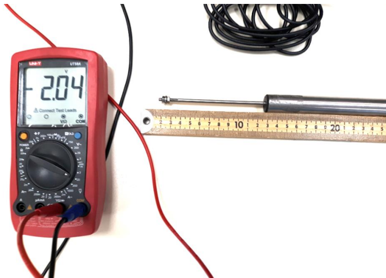
Mjerenje pomaka pomoću diferencijalnog transformatora
