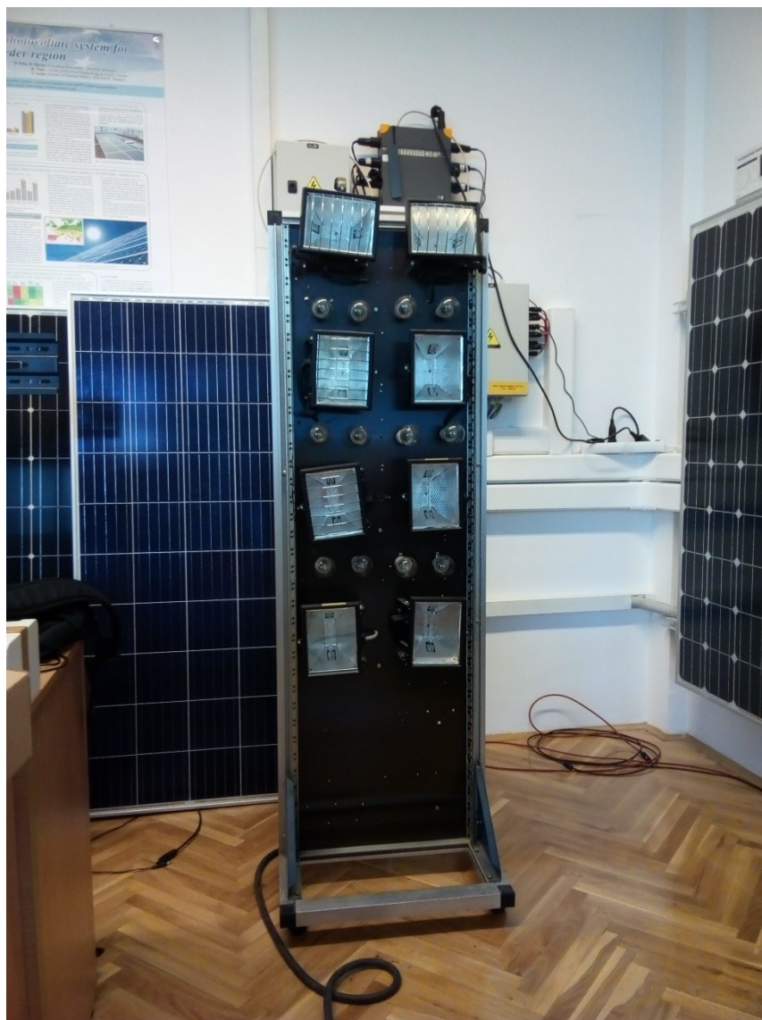
Slika 4.2. Umjetni izvor Sunčevog zračenja snage 5 kW
