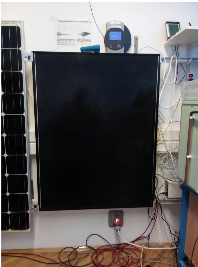
Slika 4.3. Fotonaponski modul SOLAR FRONTIER SF 150-S
