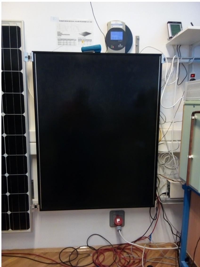
*Slika 4.3. Fotonaponski modul SOLAR FRONTIER SF 150-S*
