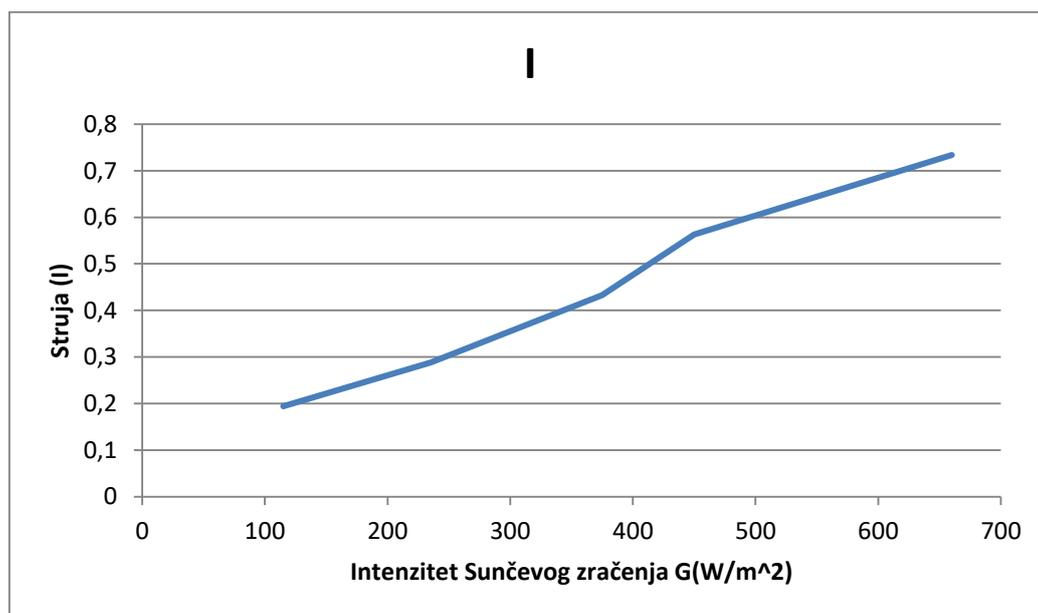
*Slika 4.10. Ovisnost struje o promjeni intenziteta Sunčevog zračenja za modul Bisol BMU - 250*
