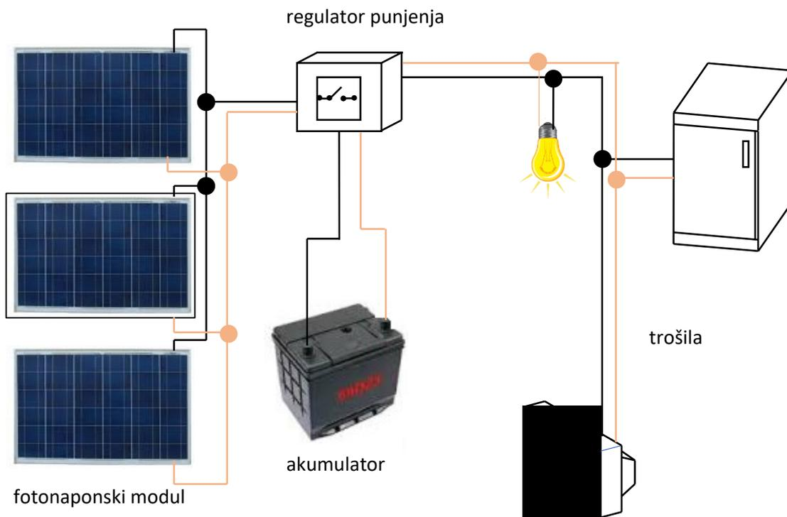
**Slika 2.6.** Otočni fotonaponski sustav za trošila na istosmjernu struju
