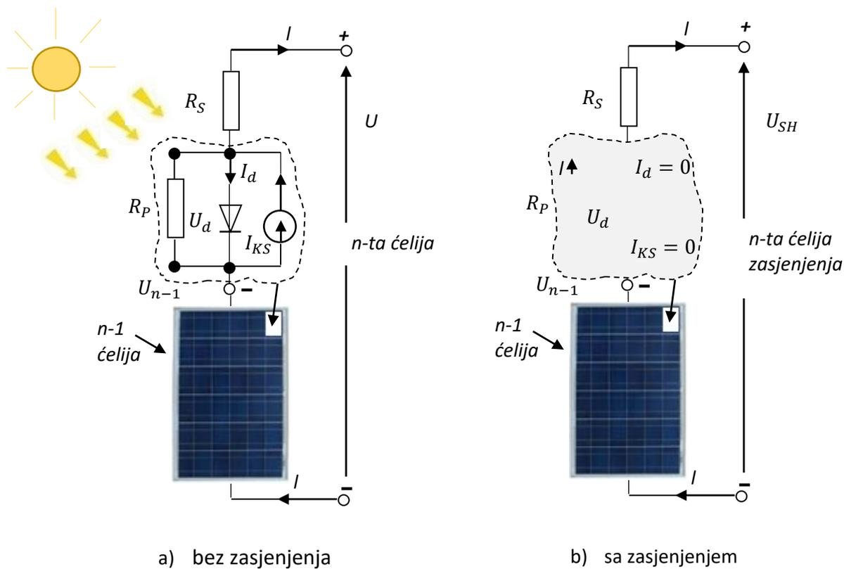
**Slika 3.13.** Fotonaponski moduli sa i bez zasjenjenja
