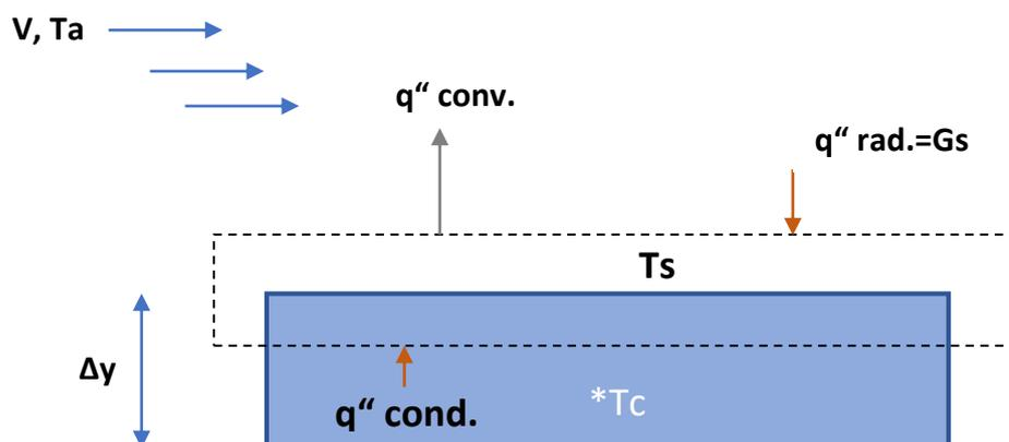
*Slika 3.3. Načini prijenosa topline na površini fotonaponske ćelije*
