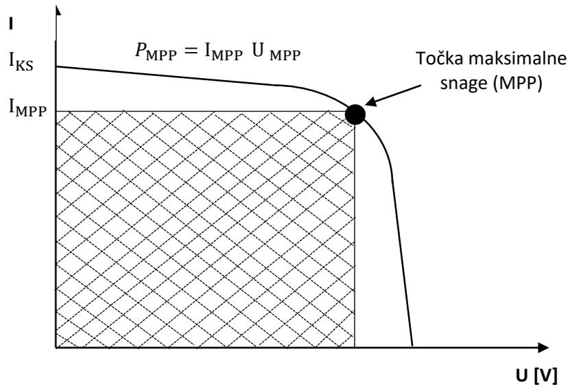
**Slika 2.9.** Strujno - naponska karakteristika FN ćelija pod osvjetljenjem
