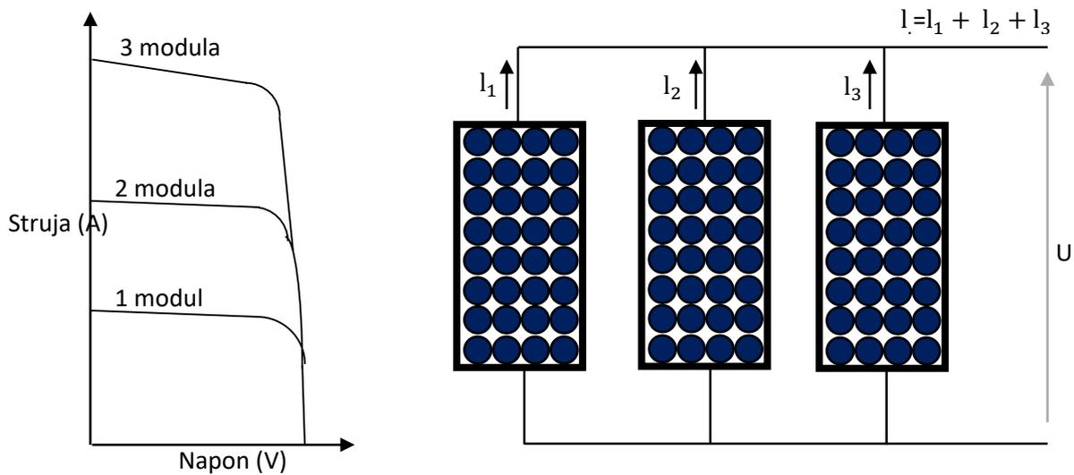
*Slika 2.4. Paralelni spoj fotonaponskih modula i pripadajuća  $U - I$  karakteristika*
