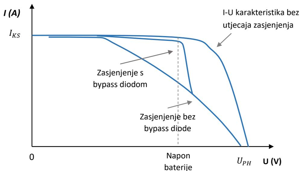
Slika 3.15. Utjecaj prenosne diode na karakteristike FN modula
