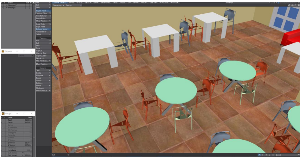
Slika 3.1.3. Prikaz problematike izvrnutih poligona. Poligoni koji fale su tu, ali su okrenuti u krivom smjeru.
