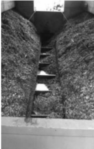
Gorivo – drvna sječka priprema i doziranje goriva
