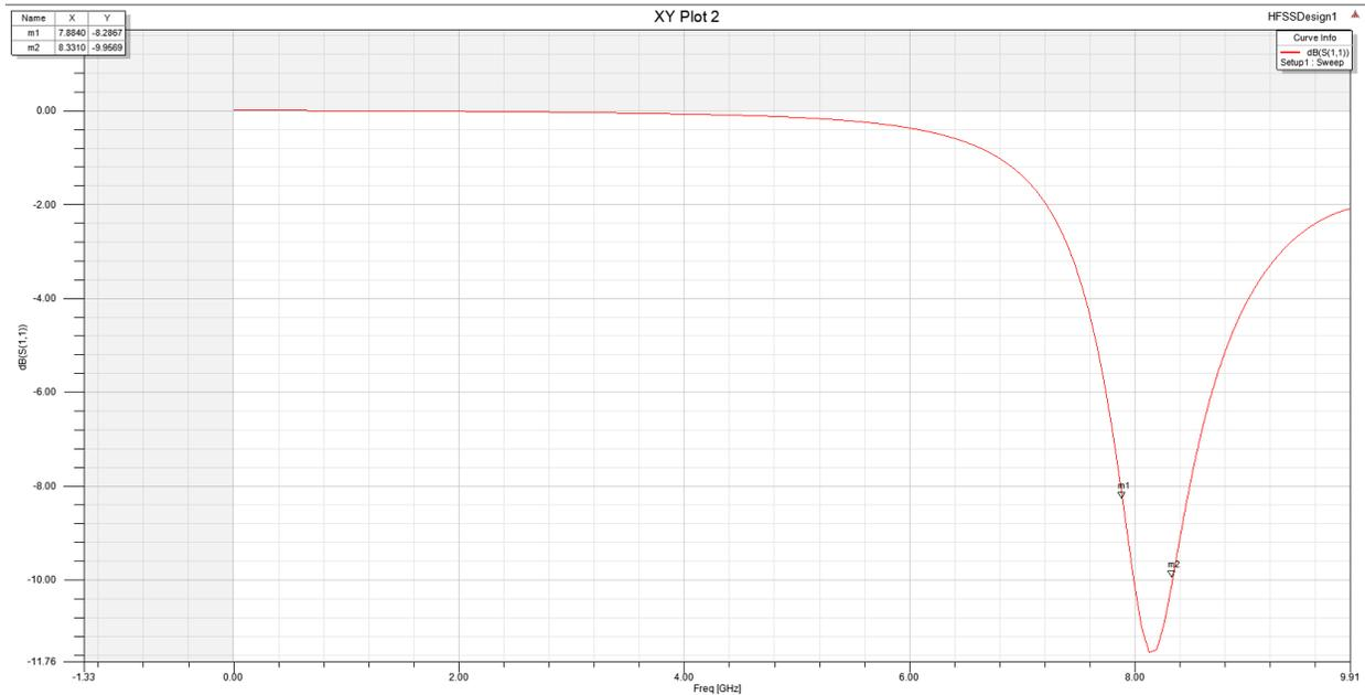
**Slika 4.21.** Parametar S11 cilindrične DRA pobuđene monopolom preko koaksijalnog porta sa dielektrikom relativne dielektrične konstante  $\epsilon_r = 30$  u ovisnosti o frekvenciji.
