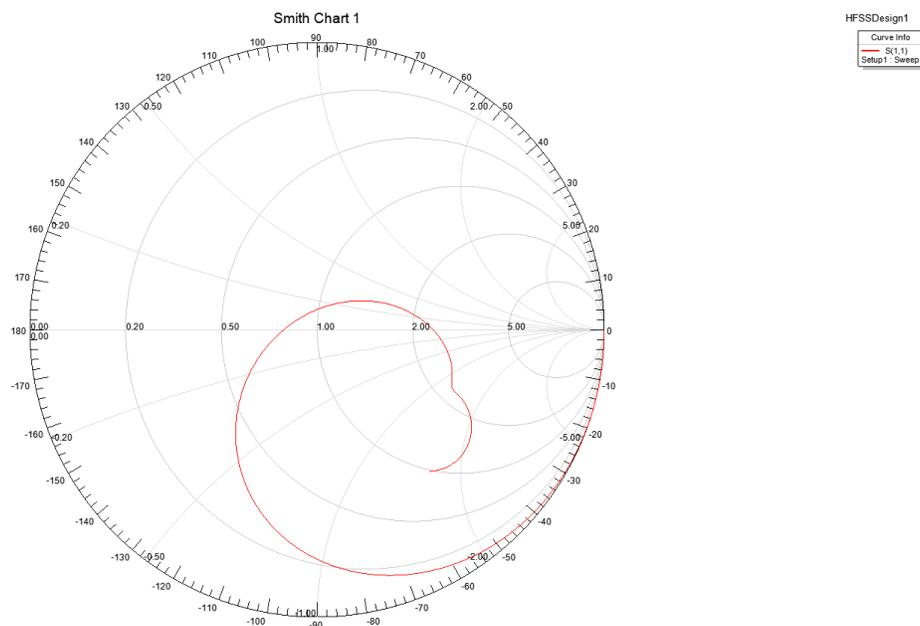
**Slika 4.17.** Smithov dijagram cilindričnog DRA pobuđenog monopolom preko koaksijalnog porta sa dielektrikom relativne dielektrične konstante  $\epsilon_r = 1$ .
