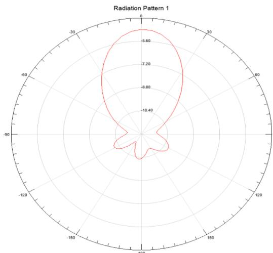
**Slika 4.22.** Polarni dijagram zračenja cilindrične DRA pobuđene monopolom preko koaksijalnog porta sa dielektrikom relativne dielektrične konstante  $\epsilon_r = 30$  u ravnini  $\phi=0$ .
