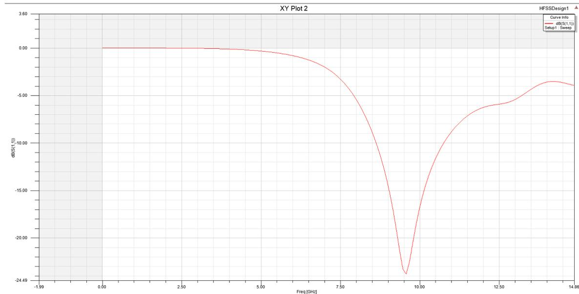
**Slika 4.15.** Parametar  $S_{11}$  cilindričnog DRA pobuđenog monopolom preko koaksijalnog porta sa dielektrikom relativne dielektrične konstante  $\epsilon_r = 1$  u ovisnosti o frekvenciji.
