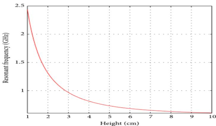
**Slika 2.4.** Rezonantne frekvencije cilindričnog DRA sa  $\epsilon_r = 10$  kao funkcija: a) radijusa i b) visine ( $h$ ) [1]
