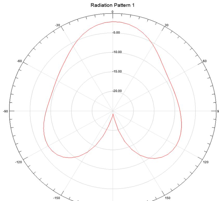
**Slika 4.16.** Polarni dijagram zračenja cilindričnog DRA pobuđenog monopolom preko koaksijalnog porta sa dielektrikom relativne dielektrične konstante  $\epsilon_r = 1$  u ravni  $\varphi=0$ .
