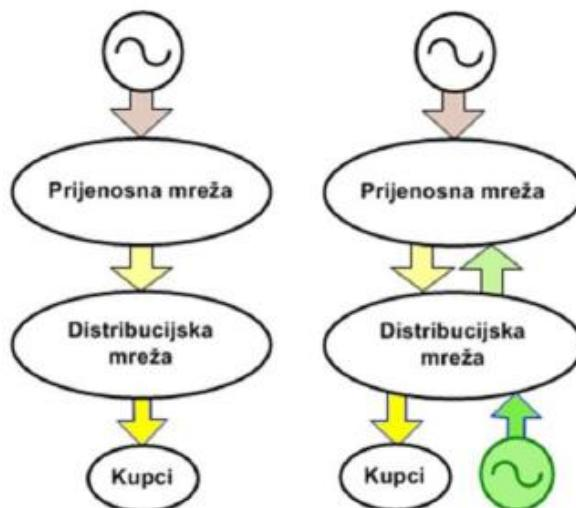
Slika 4.1. Pasivni i aktivni elektroenergetski sustav, [6].
