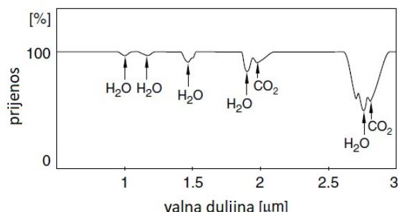
Slika 5.2. Valne duljine za prijenos i apsorpciju vodene pare u zraku u infracrvenom području.
