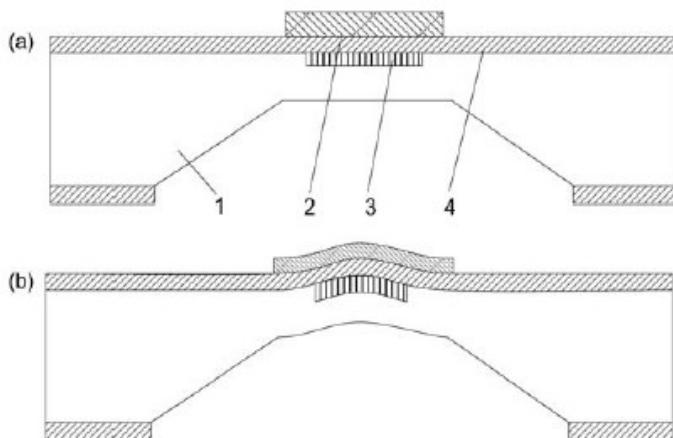
Slika 3.14. Higroskopska poliimidna folija pričvršćena na piezoelektrični element.
