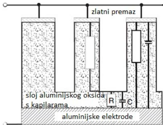
Slika 3.2. Kompleksni električni otpor senzora metalnih oksida.
