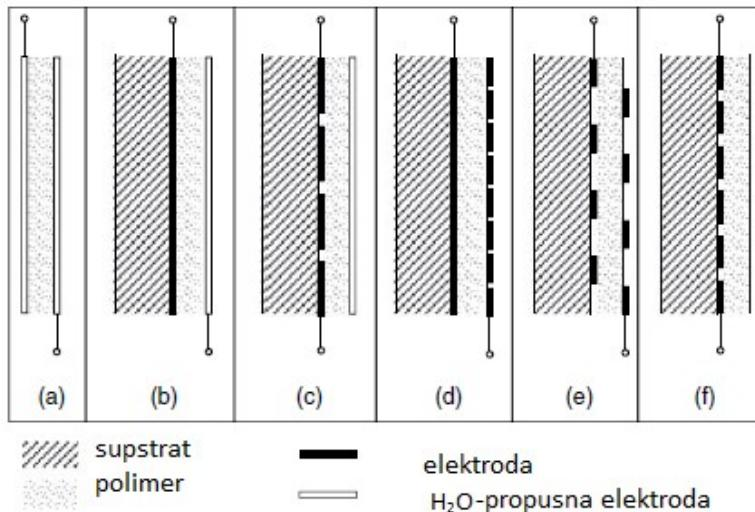
Slika 3.6. Vrste slaganja slojeva u kapacitivnom polimernom senzoru.
