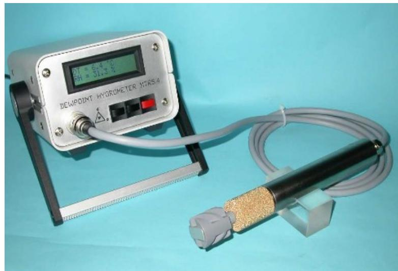
Slika 3.8. Mjerni instrumenti za određivanje točke rosišta. [14]
