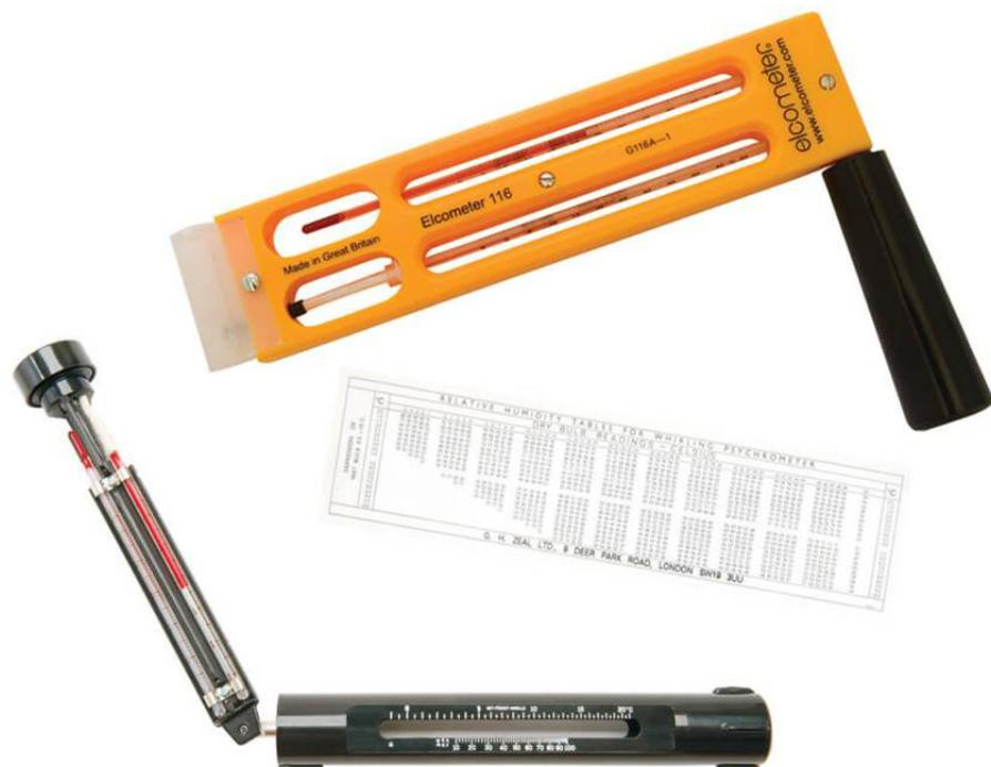
Slika 3.4. Centrifugalni psihrometar i tablica. [13]
