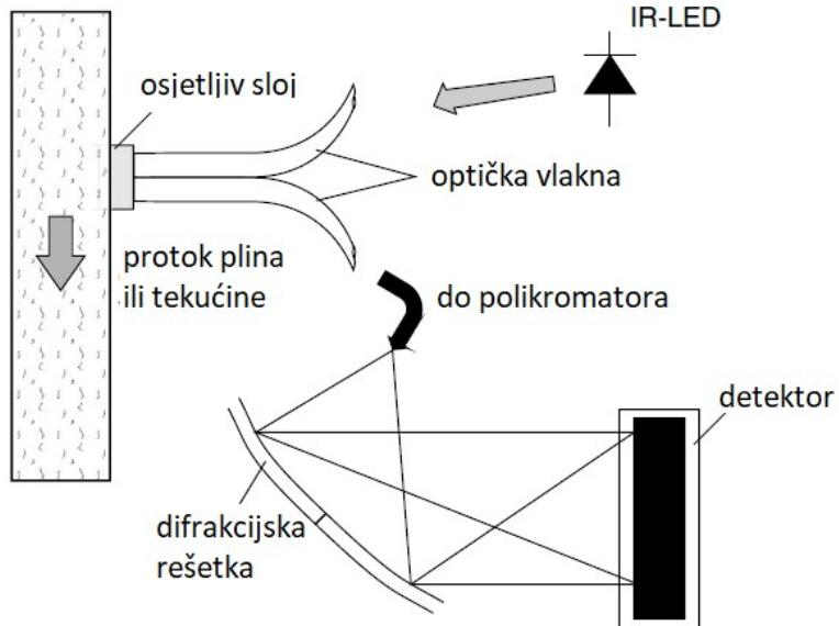
Slika 5.6. Sustav za mjerjenje vlažnosti plinova i tekućina s optičkim vlaknima.
