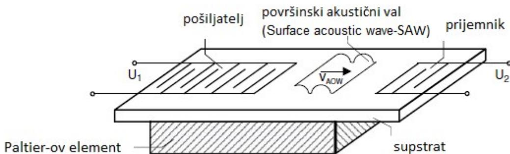
Slika 3.10. Instrument za mjerjenje točke rosišta površinskog akustičnog vala.
