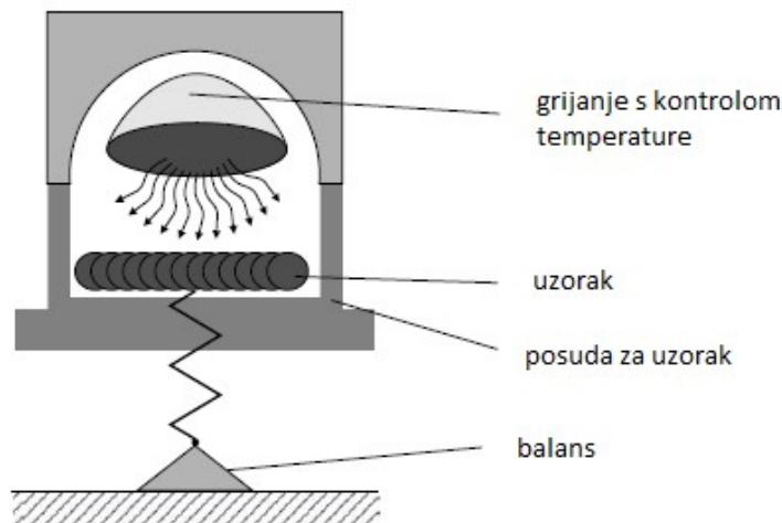
Slika 8.1. Termogravimetrijski uređaj za mjerjenje vlage.
