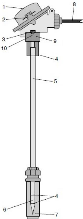
Slika 7.1. Tensiometar za mjerjenje vlage tla. 1 - kućište, 2 - pojačalo signala, 3 - pretvarač pritiska, 4 - brtveni prsten, 5 - okomita cijev, 6 - čelija tensiometra, 7 – zaštitni pokrov, 8 - ulaz, 9 - transportna brtva, 10 - indikator mjehurića. [2]
