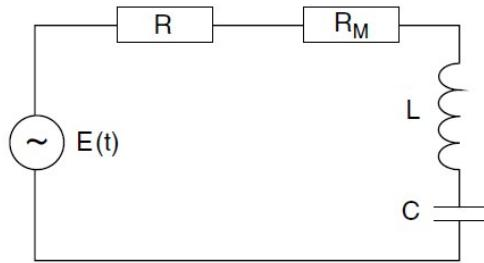
Slika 2.3. Ekvivalentna shema za mjerena s induktivitetom  $L$ , kapacitetom  $C$ , otporom  $R$  i izvorom napona  $E$ . [2]
