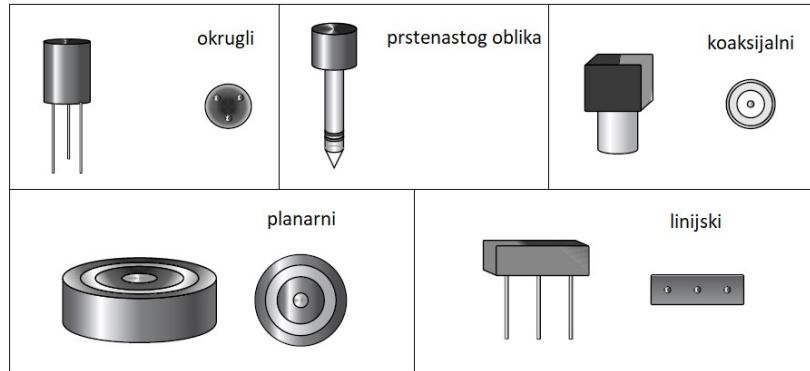
Slika 2.2. Različiti oblici elektroda za električno spajanje mjernog signala u materijalu.
