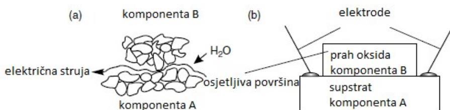
Slika 3.15. Keramičko-otporički senzor vlage.
