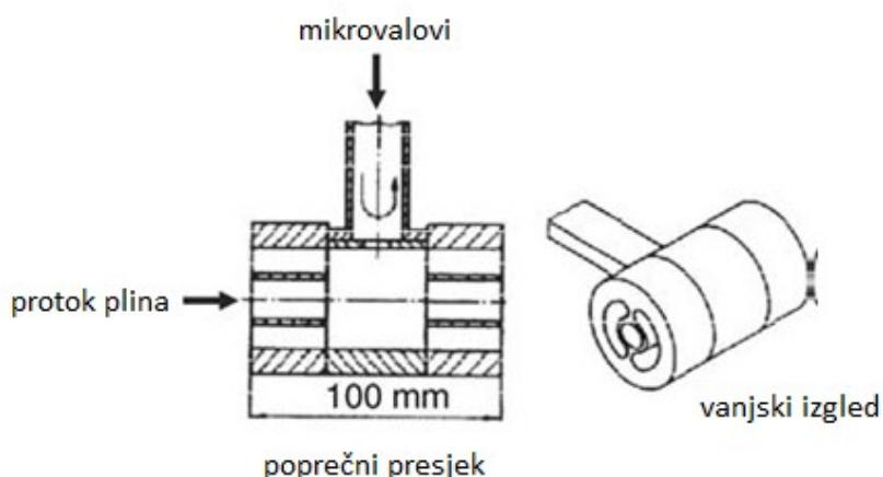
Slika 2.10. Rezonator za mjerjenje vlažnosti plina pomoću mikrovalova.
