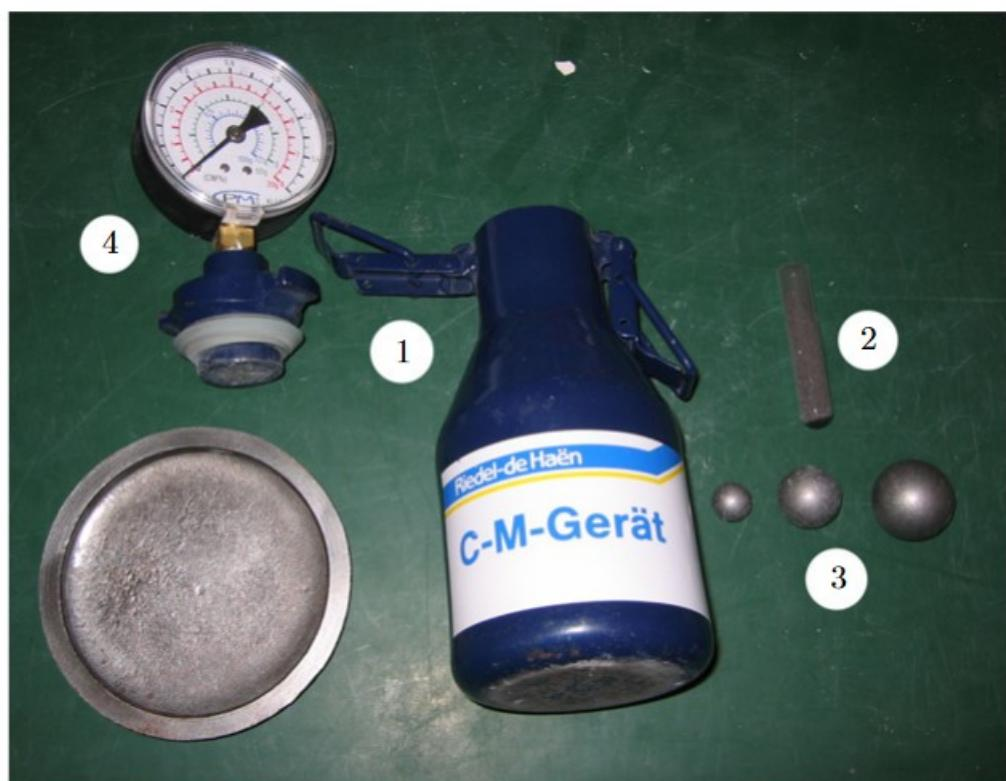
Slika 4.3. Oprema za mjerjenje vlege metodom s kalcijevim karbidiom: 1-posuda s plinom pod tlakom, 2-ampula kalcijevog karbida, 3-čelične kuglice, 4-mjerač. [3]
