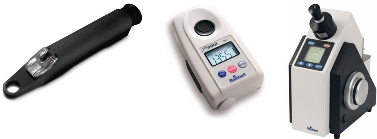
Slika 5.5. Reflektometrijski uređaji za mjerenje vlage. [4]
