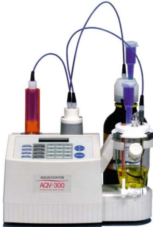
Slika 4.6. Primjer uređaja za mjerenje metodom titranja po Karl Fischer-u. [4]
