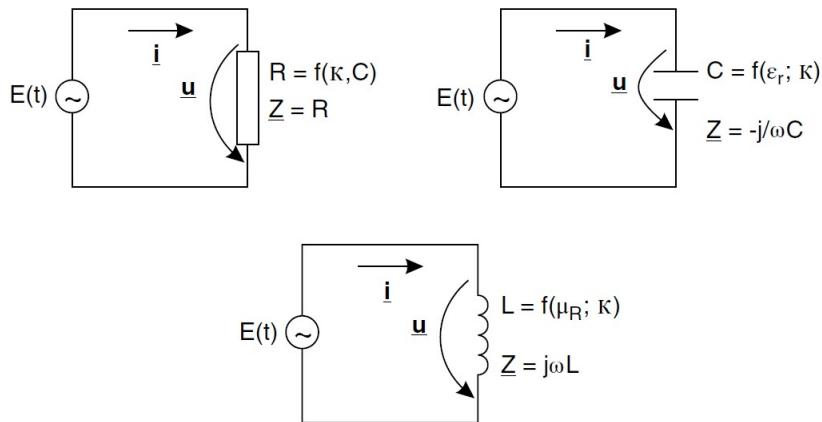
Slika 2.4. Ekvivalentna shema kruga impedancije  $Z$ , koja ovisi o obliku i dimenzijama elektroda i specifičnim parametrima materijala ( $\kappa$  je specifična vodljivost,  $\epsilon_r$  je relativna permitivnost,  $\mu_r$  je relativna permeabilnost). [2]
