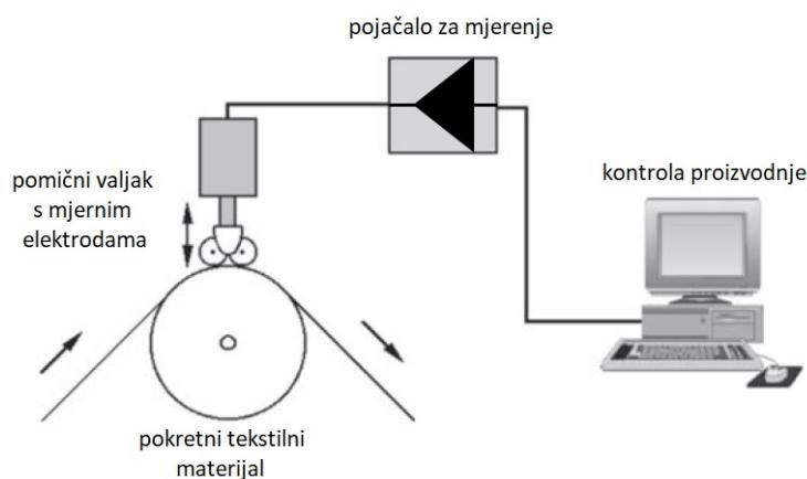
Slika 2.6. Niskofrekventni mobilni mjerni uređaj za mjerjenje vlage u nitima pređe.
