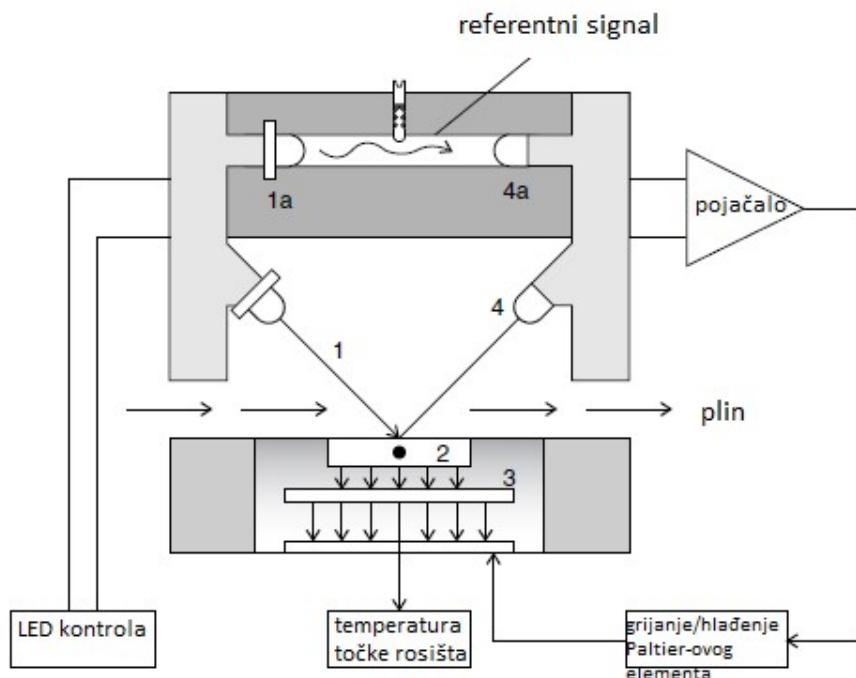
Slika 3.7. Postavljanje ogledala točke rosišta. 1 - LED kao izvor svjetlosti, 1a - referentni signal, 2 - visoko reflektirajuća površina (ogledalo) s temperaturnim senzorom, 3 - grijajuća jedinica, 4 - optički prijemnik, 4a - optički prijemnik referentnog signala.
