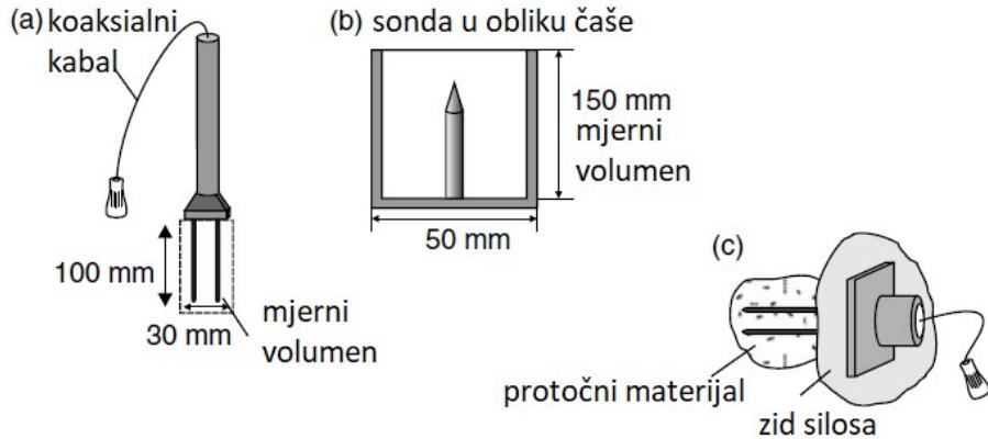
Slika 2.8. Različiti oblici sondi za mjerjenje reflektometrije vremenske domene: (a) lancetna sonda, (b) sonda u obliku čaše, (c) sonda za zidnu montažu.
