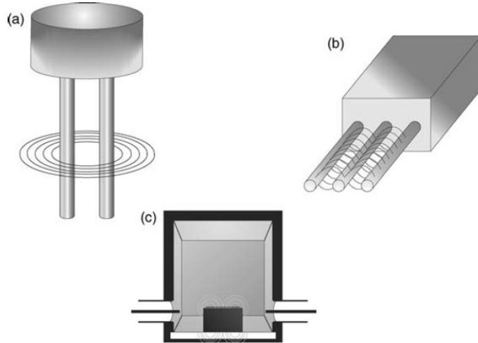
Slika 2.7. Senzori za mjerjenje vlage pomoću visoke frekvencije s različitim mjernim parametrima. (a) Metoda reflektometrije vremenske domene: mjerjenje razlike u dužini trajanja. (b) Metoda reflektometrije frekvencijske domene: mjerjenje razlike u frekvenciji. (c) Rezonatorska metoda: mjerjenje neusklađenosti oscilirajućeg kruga. [2]
