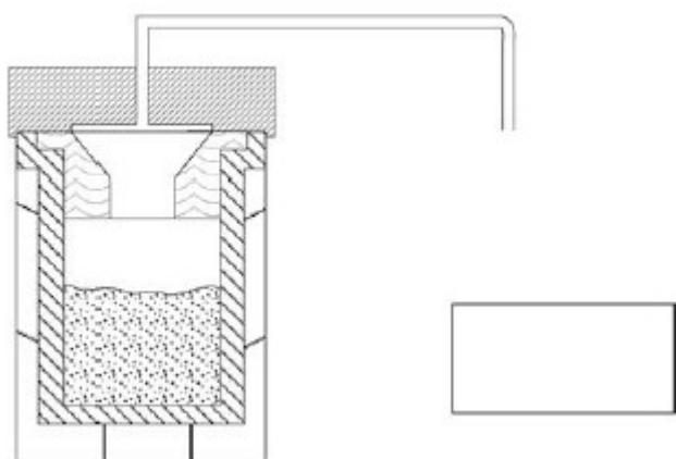
Slika 4.5. Uređaj za mjerjenje vlažnosti pomoću kalcijevog hidrida. [2]
