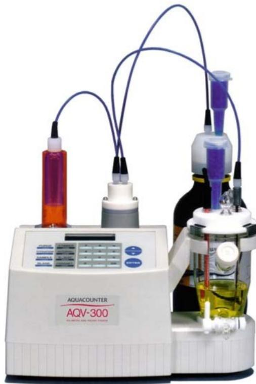
Slika 4.6. Primjer uređaja za mjerjenje metodom titranja po Karl Fischer-u. [4]
