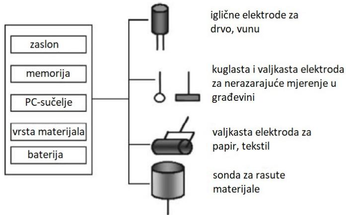
Slika 2.5. Električne komponente za mjerjenje vlage.
