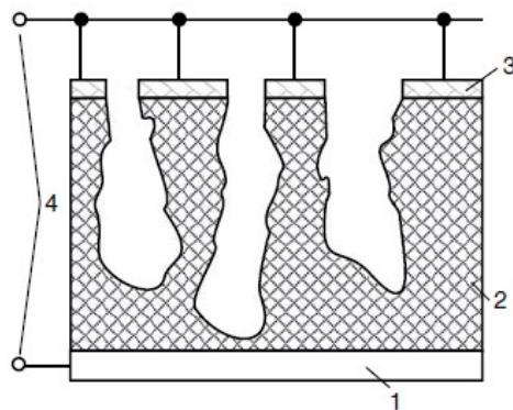
Slika 3.1. Sastav senzora s aluminijskim oksidom. 1 - aluminijска подлога; 2 - osjetljiv sloj metalnog oksida s kapilarama; 3 - pokrovna elektroda; i 4 - električni priključci. [2]
