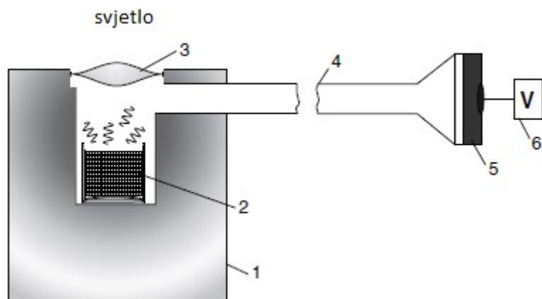
Slika 6.1. Fotoakustični senzor (PAS). 1 - aluminijski blok, 2 - komora s uzorkom, 3 - volumen koji definira rezonancu, 4 – mikrofon, 5 - pojačalo, 6 - voltmeter.
