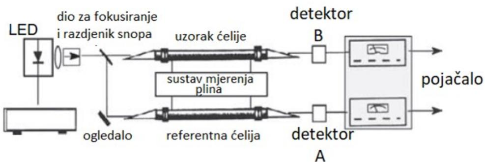
Slika 5.3. Mjerenje vlage u tekućinama optičkim prijenosom.
