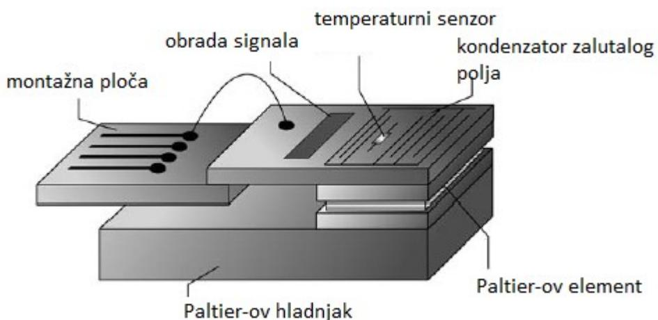
Slika 3.9. Instrument za mjerjenje točke rosišta prema Heinzeu.
