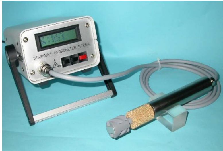
Slika 3.8. Mjerni instrumenti za određivanje točke rosišta. [14]
