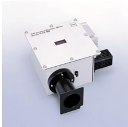
Slika 5.1. Uređaj za mjerjenje vlage pomoću infracrvenog zračenja. [10]
