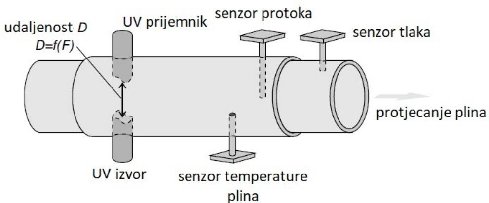
Slika 5.5. UV higrometar za protok plina velike brzine.
