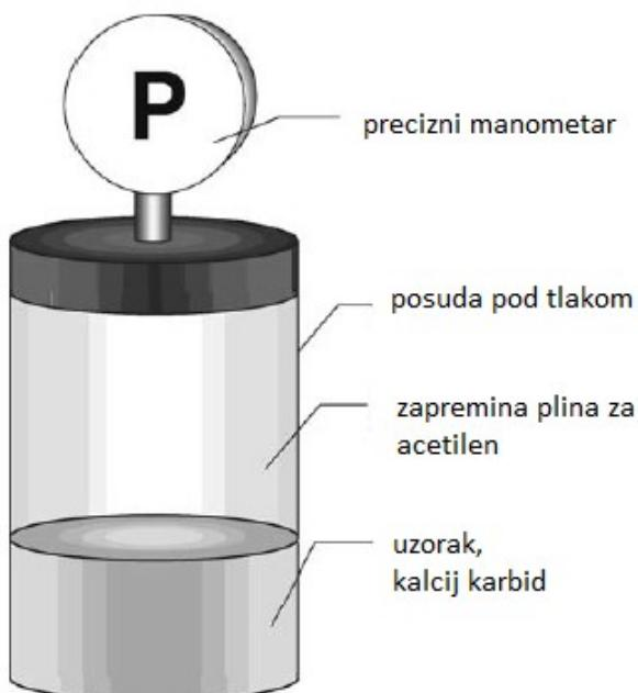
Slika 4.4. Tlačna komora uređaja za mjerjenje pomoću kalcijevog karbida.
