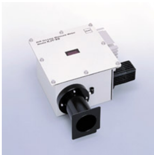
Slika 5.1. Uređaj za mjerenje vlage pomoću infracrvenog zračenja. [10]
