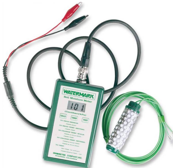
Slika 7.3. Uređaj za mjerenje vlage pomoću bloka gipsa. [16]
