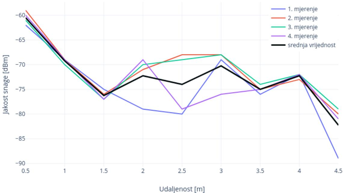
Sl. 5.7. Ovisnost snage o udaljenosti kod komercijalnog Bluetooth odašiljača
