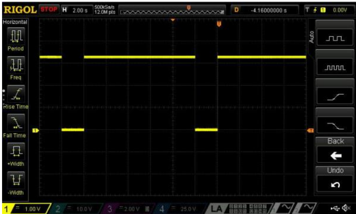
Slika 4.4. Valni oblik napona na sklopki balancerskog podsustava [32]
