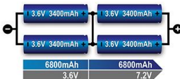
Slika 2.9. Serijsko-paralelni spoj četiri baterijske ćelije [19]
