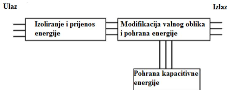
Slika 5.4. Blok shema magnetskog sintenzatora [1, str. 64]
