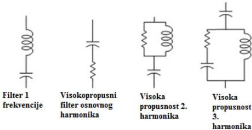
Slika 5.11. Tipične izvedbe pasivnih filtera [1, str. 252]
