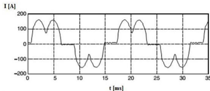
Slika 4.1. Valni oblik struje trofaznog ispravljača [1, str. 189]
