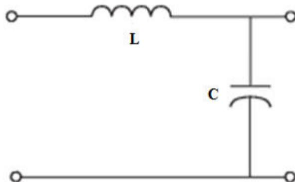
Slika 5.14. Shema niskopropusnog širokopojasnog filtera [1, str. 258]
