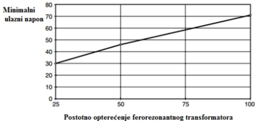
Slika 5.3. Naponski propad pod opterećenjem ferorezonantnog transformatora [1, str. 63]
