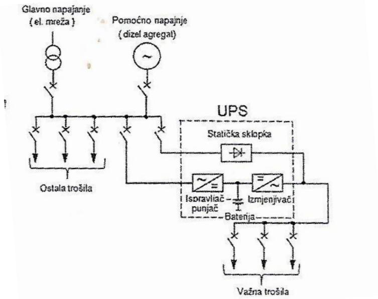
Slika 5.5. Blok shema UPS sustava
