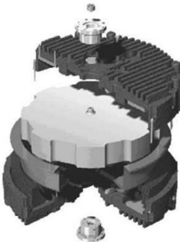
Slika 5.8. Zamašnjak za pohranu energije [1, str.69]
