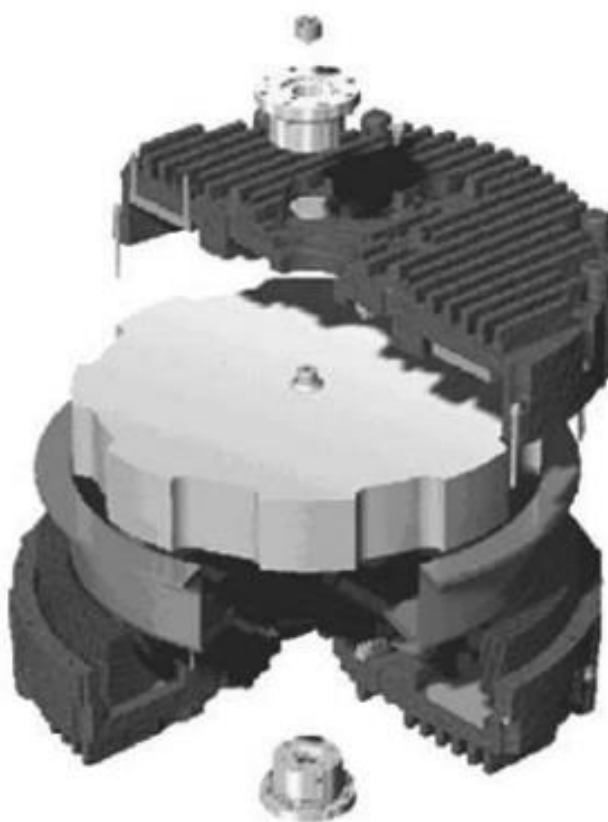
Slika 5.8. Zamašnjak za pohranu energije [1, str.69]
