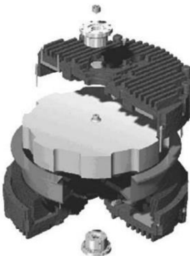
Slika 5.8. Zamašnjak za pohranu energije [1, str.69]
