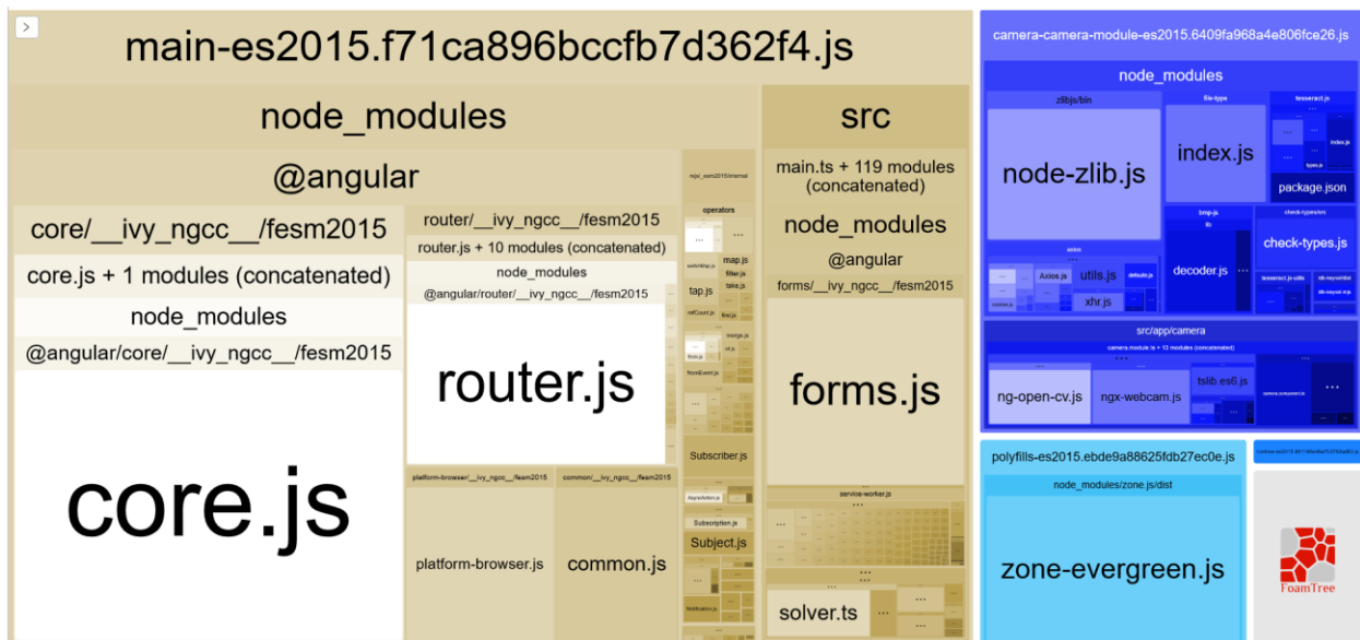
Slika 4.3. Stvorene JavaScript datoteke nakon izgradnje Angular aplikacije s njihovim zavisnim modulima (veličina je proporcionalna količini bajtova koji pojedini komad zauzima).
