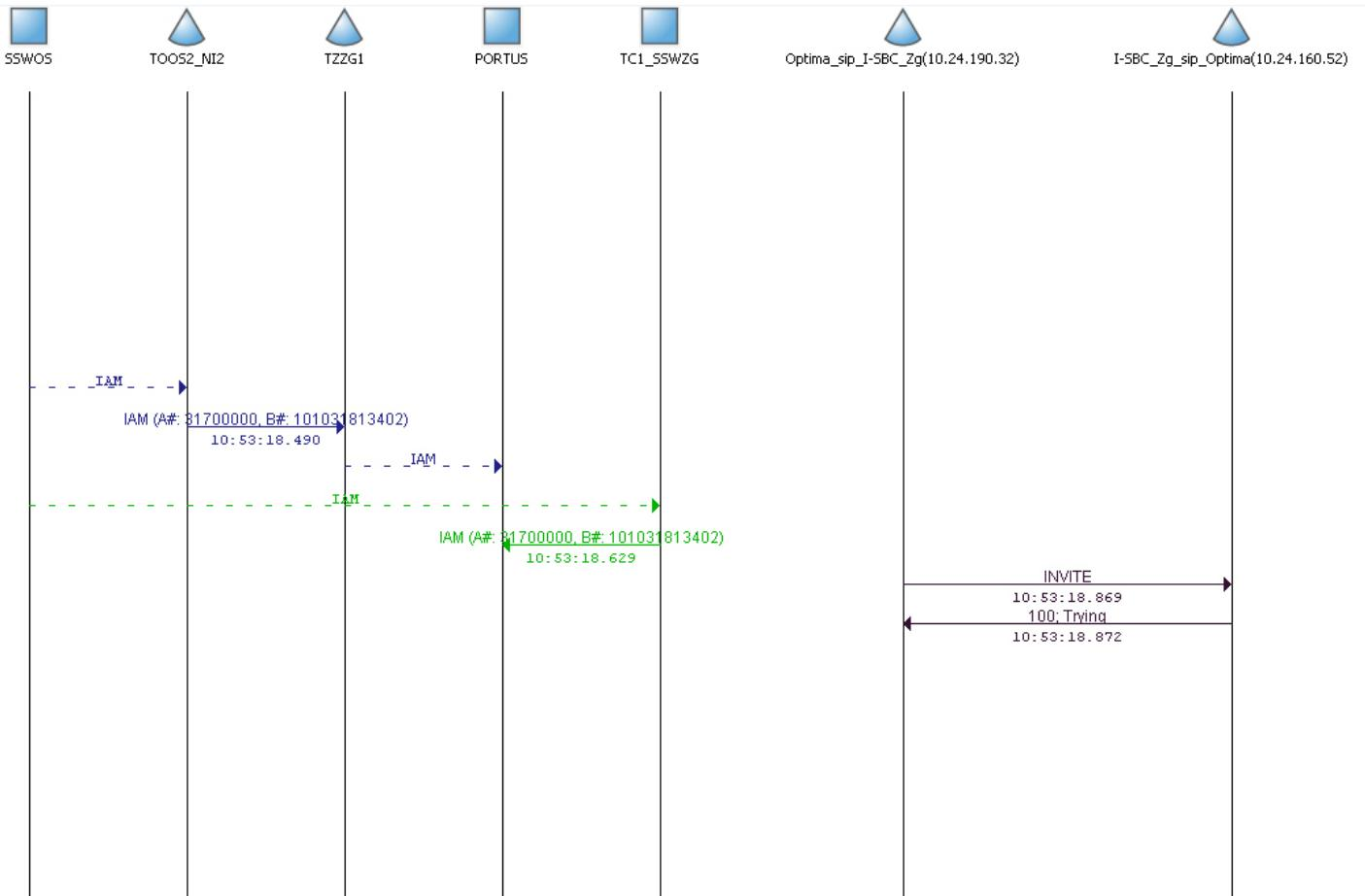
**Slika 2.2.3.** Signalizacijski dijagram stvarnog CPS poziva (izvadak)
