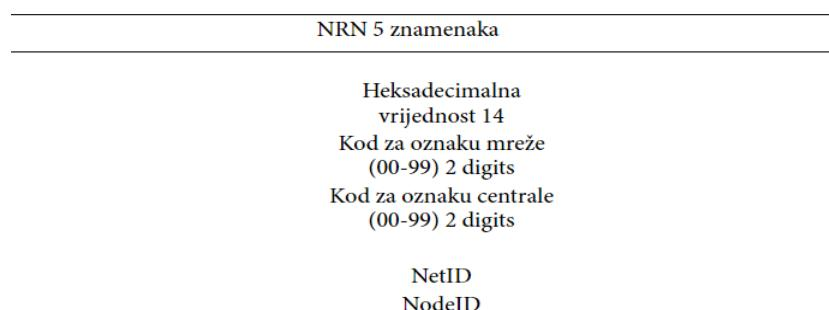
**Slika 5.1.** Struktura predbroja za usmjeravanje
