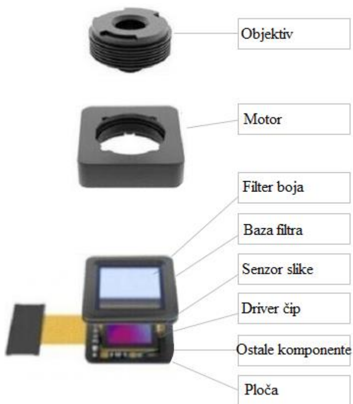
Slika 2. 4. Komponente kamere mobilnog telefona
