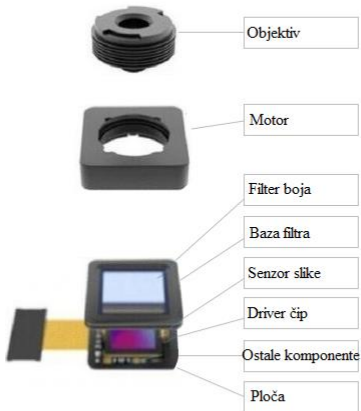
Slika 2. 4. Komponente kamere mobilnog telefona
