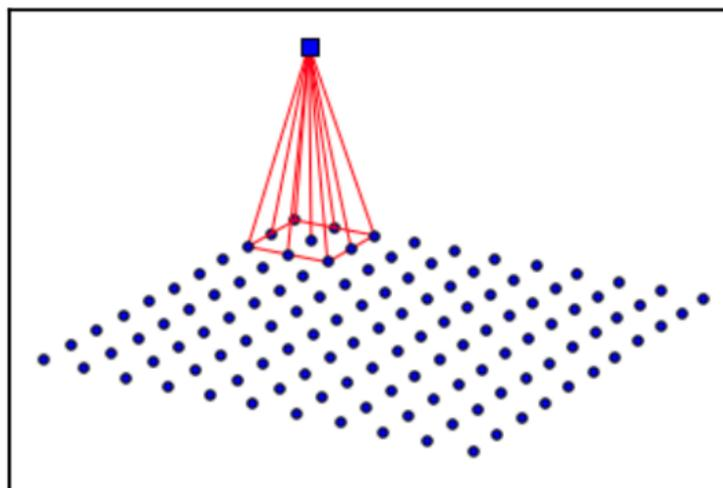
Sl. 2.5.: Primjena *kernela* na dvodimenzionalne ulazne podatke [3]
