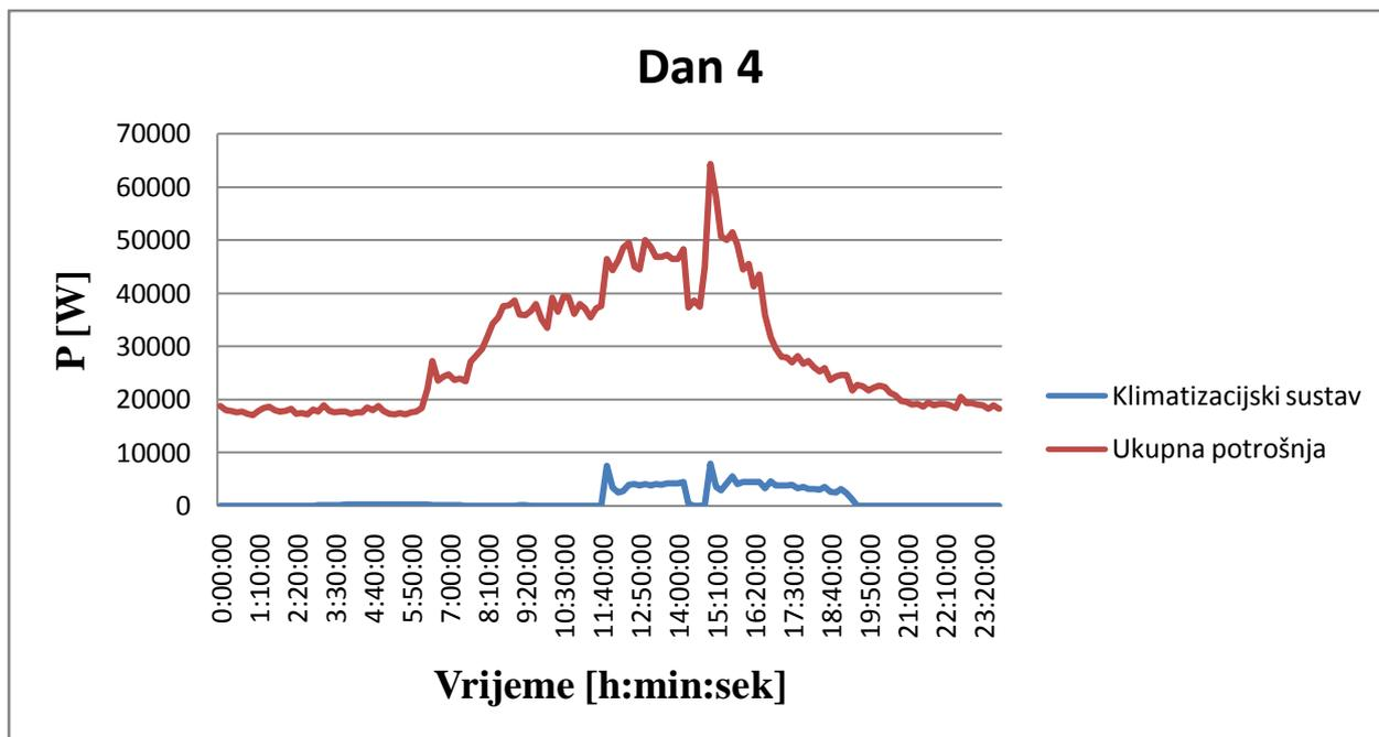
Slika 4.10. Ukupna potrošnja električne energije zgrade i klimatizacijskog sustava četvrtog dana
