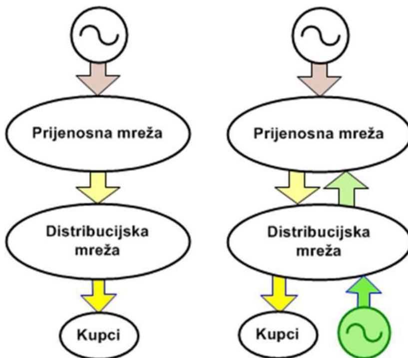
Slika 2.1. Blok dijagram pasivne (lijevo) i aktivne (desno) mreže [3]
