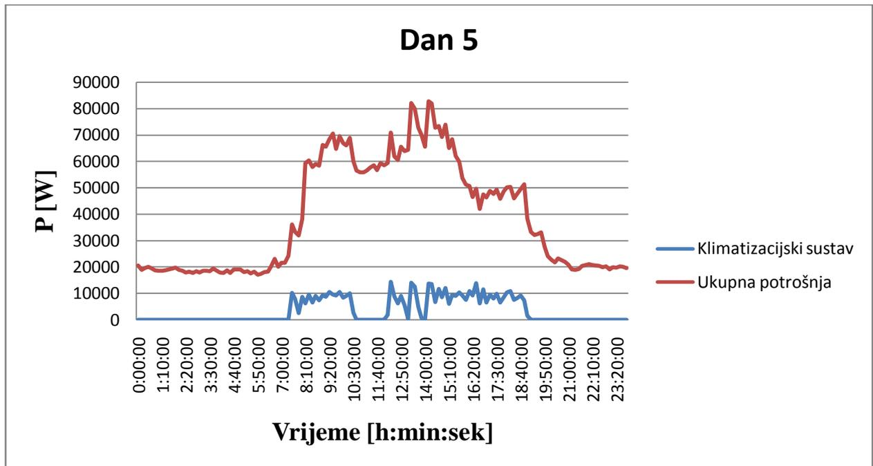
Slika 4.12. Ukupna potrošnja električne energije zgrade i klimatizacijskog sustava petog dana
