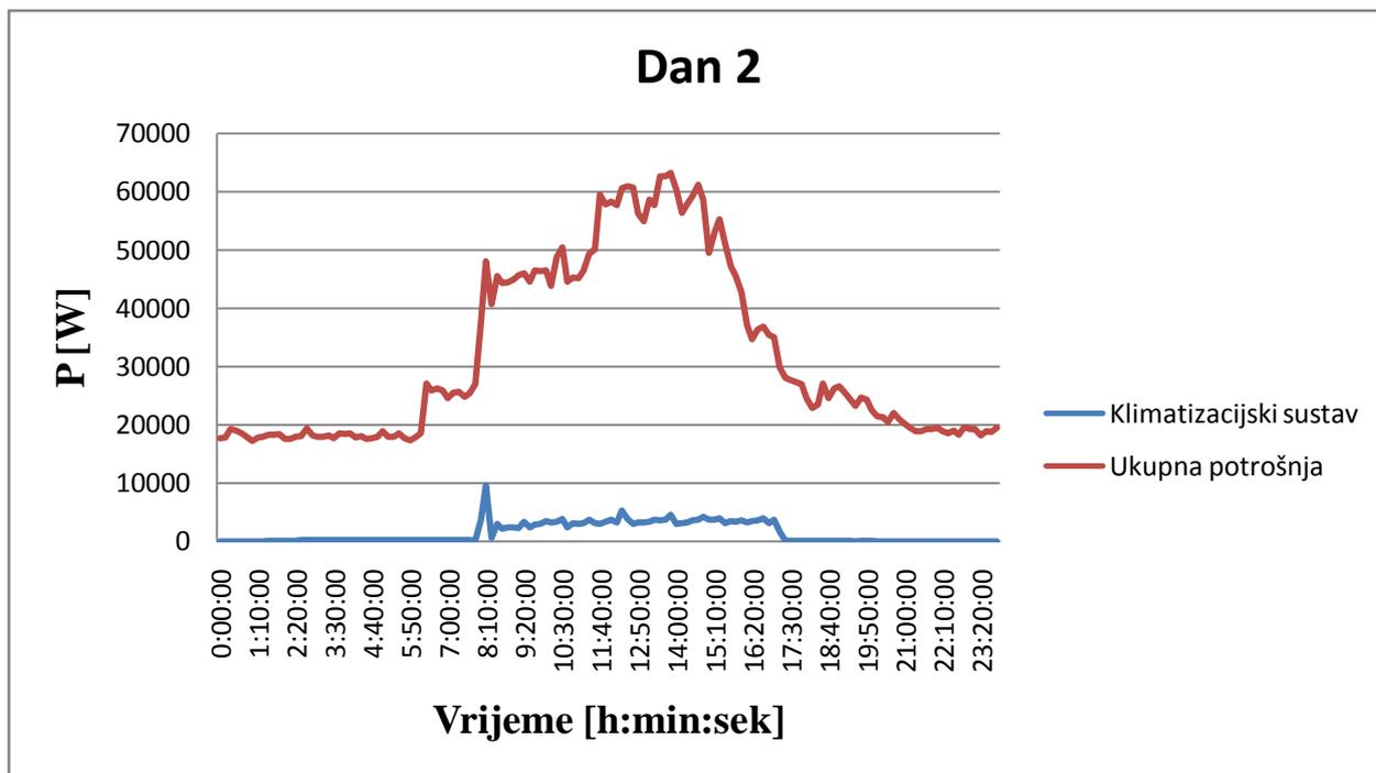
Slika 4.6. Ukupna potrošnja električne energije zgrade i klimatizacijskog sustava drugog dana
