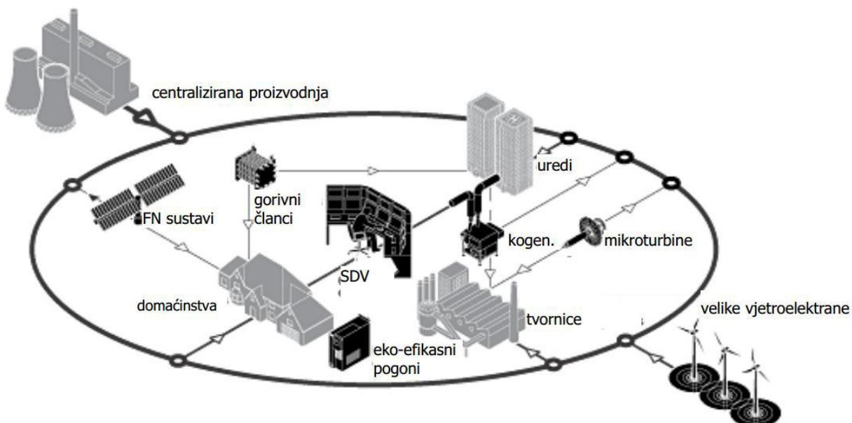
Slika 2.3. Konfiguracija elektroenergetskog sustava s distribuiranim izvorima energije [7]
