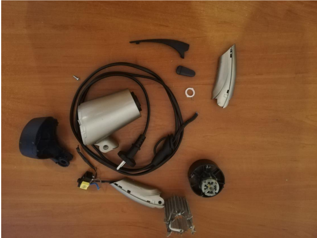
Slika 4.2. Prikaz kućišta i dijelova sušila nakon procesa rastavljanja
