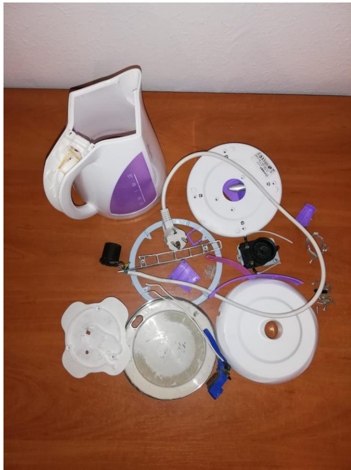
Slika 4.6. Prikaz svih dijelova nakon rastavljanja kuhala za vodu
