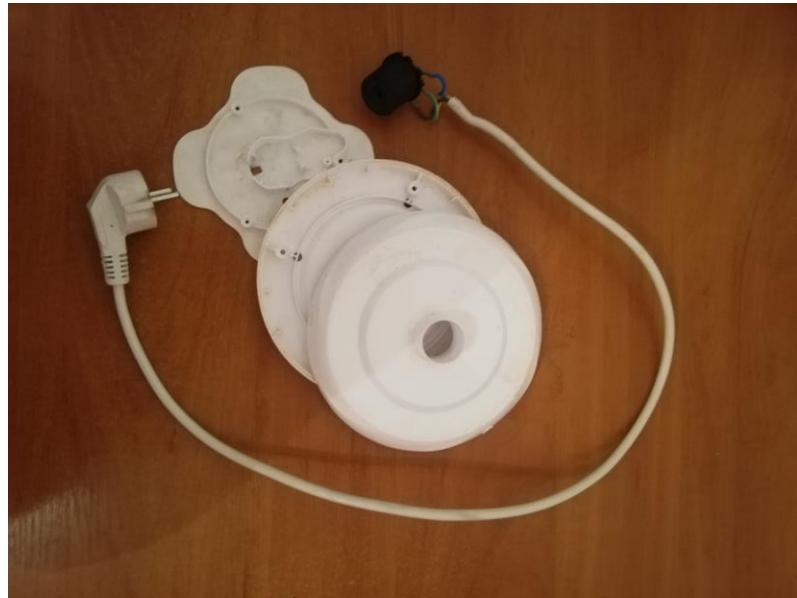
**Slika 4.8.** Dijelovi postolja nakon rastavljanja
