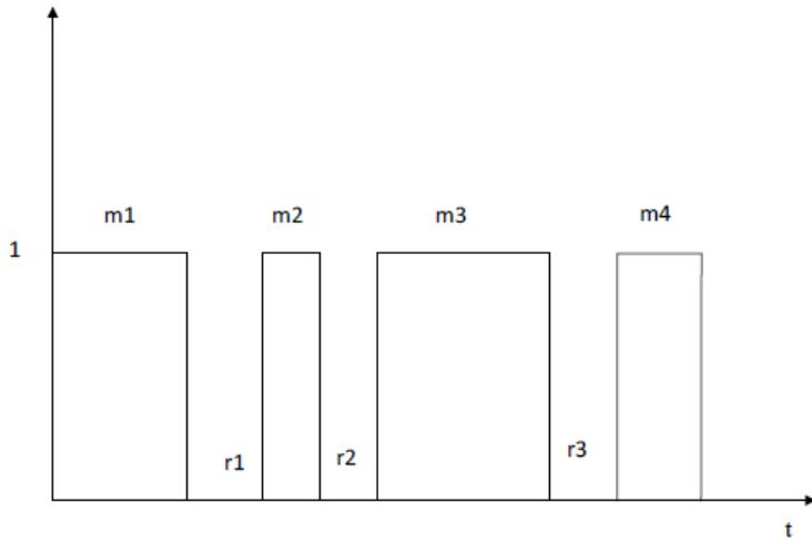
**Slika 3.2.** Razdoblja rada i popravka popravljive komponente [10]
