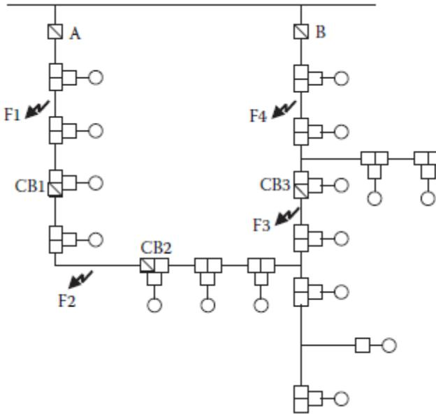
**Slika 5.4.** Dodavanje kontinuiranog alternativnog napajanja [7]
