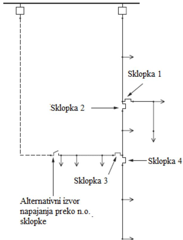
**Slika 5.1.** Dodavanje ručno upravljenih rastavnih sklopki i alternativnog izvora napajanja [7]
