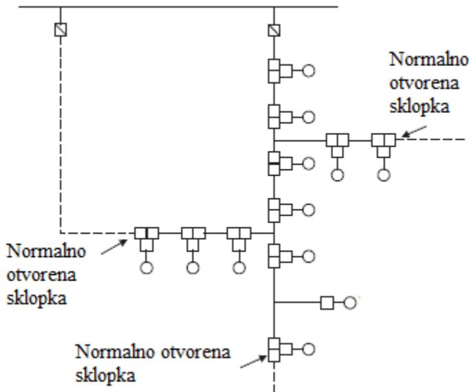
**Slika 5.2.** Dodavanje vakuumske distribucijske aparature [7]
