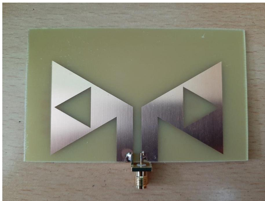
Slika 32. Sierpinskij fraktalna bow-tie antena prvog reda
