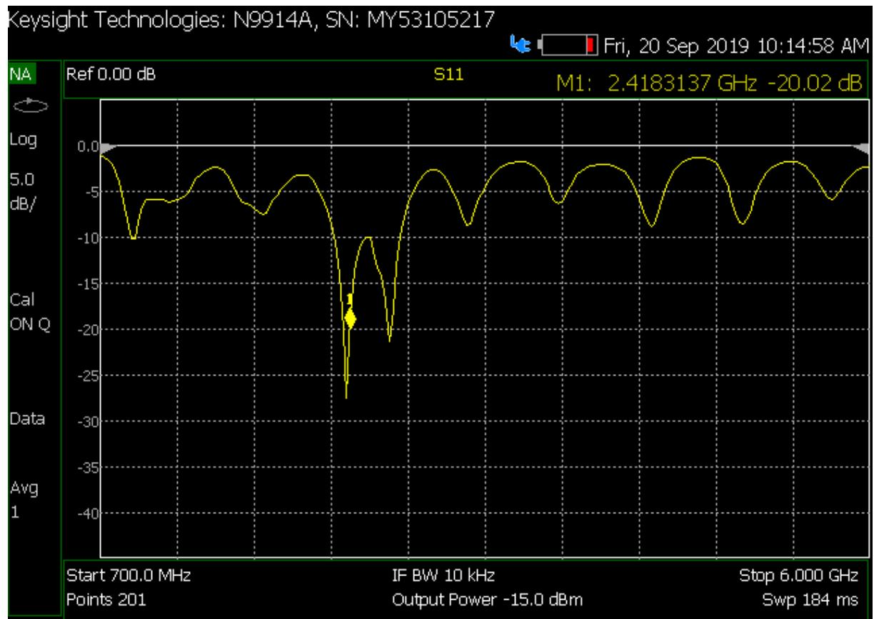
Slika 36. S<sub>11</sub> dijagram Sierpinski fraktalne bow-tie antene drugog reda
