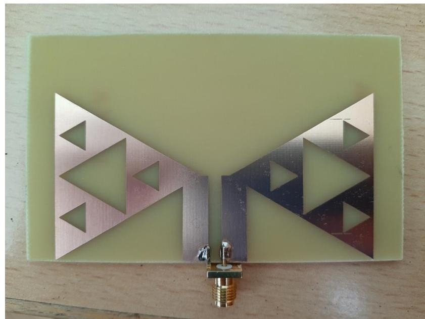
Slika 35. Sierpinski fraktalna bow-tie antena drugog reda
