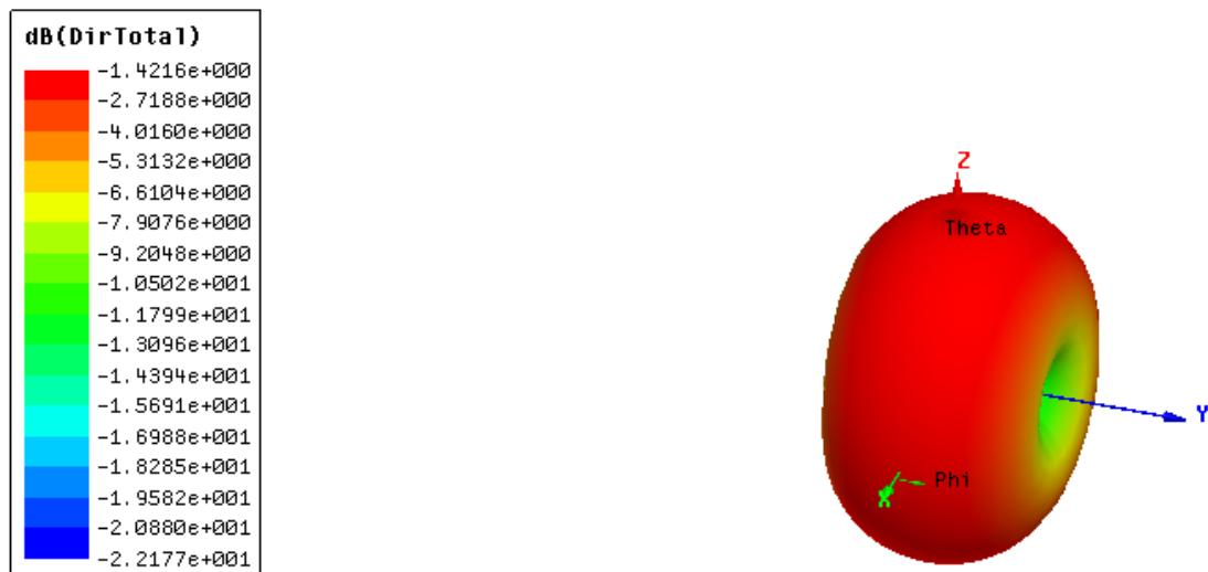
Slika 22. 3D zračenje Sierpinski fraktalne bow-tie antene drugog reda
