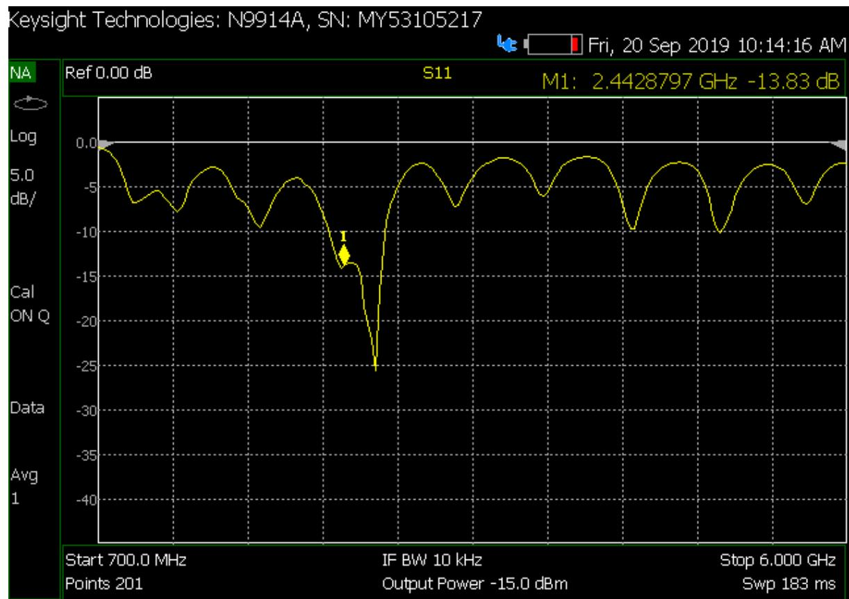
Slika 33. S<sub>11</sub> dijagram Sierpinskij fraktalne bow-tie antene prvog reda
