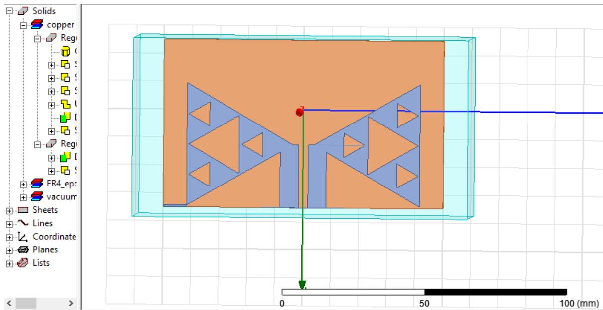
Slika 19. Izgled Sierpinski fraktalne bow-tie antene drugog reda u ANSYS- HFFS simulatoru
