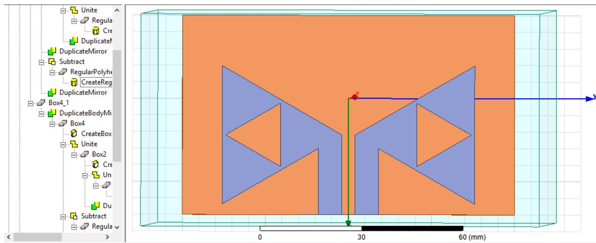
*Slika 14.* Izgled Sierpinski fraktalne bow-tie antene prvog reda u ANSYS- HFFS simulatoru
