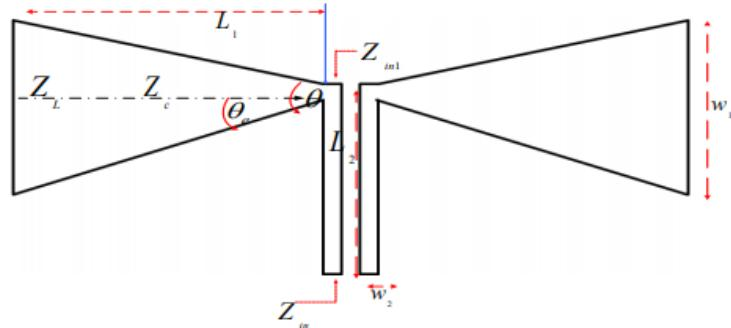
Slika 2. Parametri potrebni za izračun ulazne impedancije [6]
