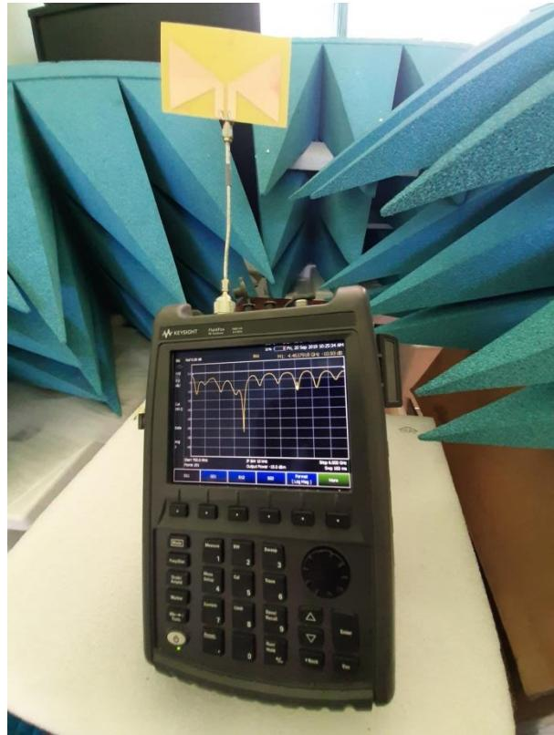
Slika 28. Mjerni instrument i antena pri mjerenu koeficijenta refleksije i ulazne impedancije
