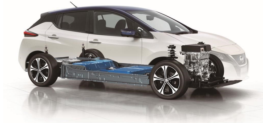
Slika 1.1 Građa električnog automobila ( https://autogaraza.hr/novosti/najprodavaniji-elektricni-automobil-svijetu/ )
