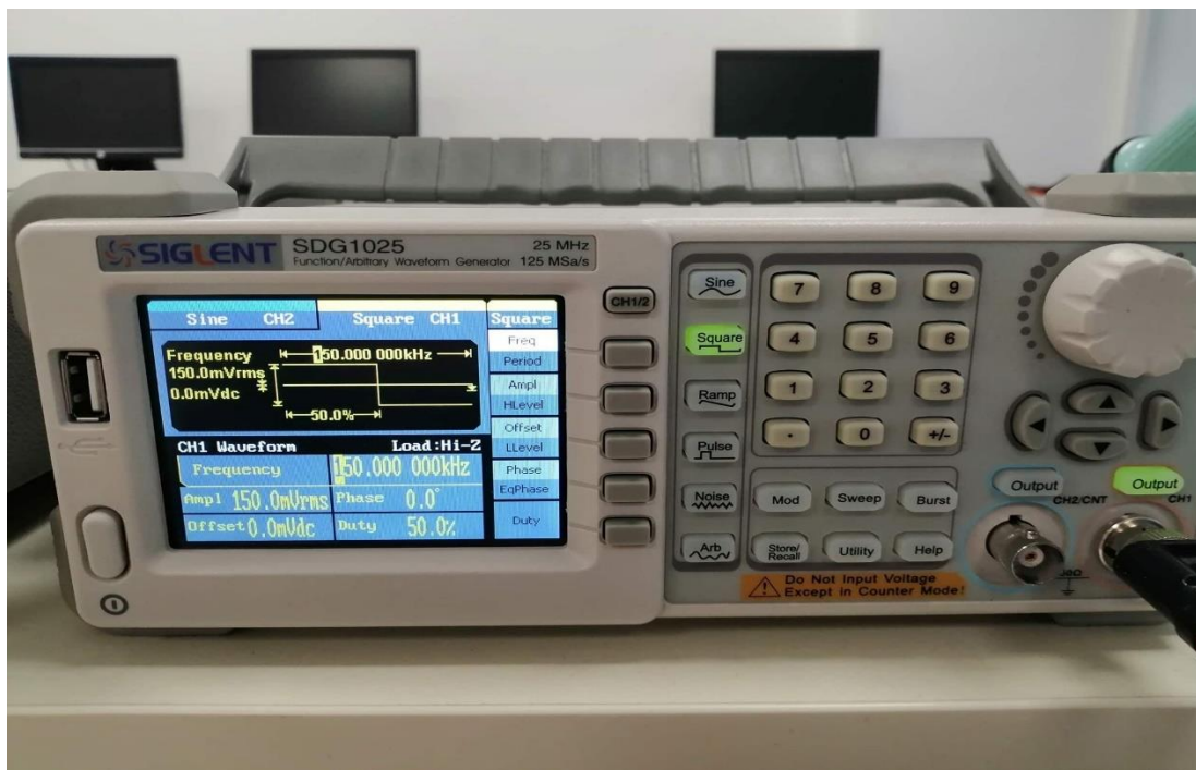
Slika 6.1. Funkcijski generator Siglent SDG1025
