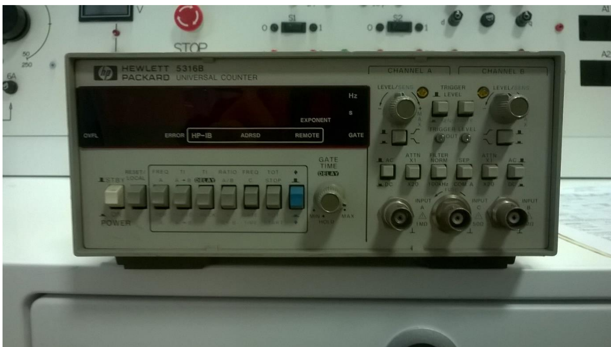
Slika 2.2. Primjer univerzalnog digitalnog brojila Hewlett Packard 5316B
