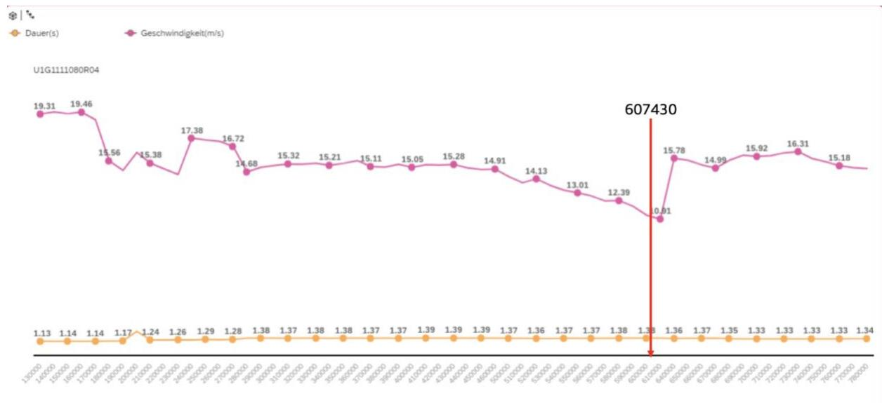
Slika 4.11: Prikaz brzine i trajanja u trenutku pogreške na robotu U1G1111080R04
