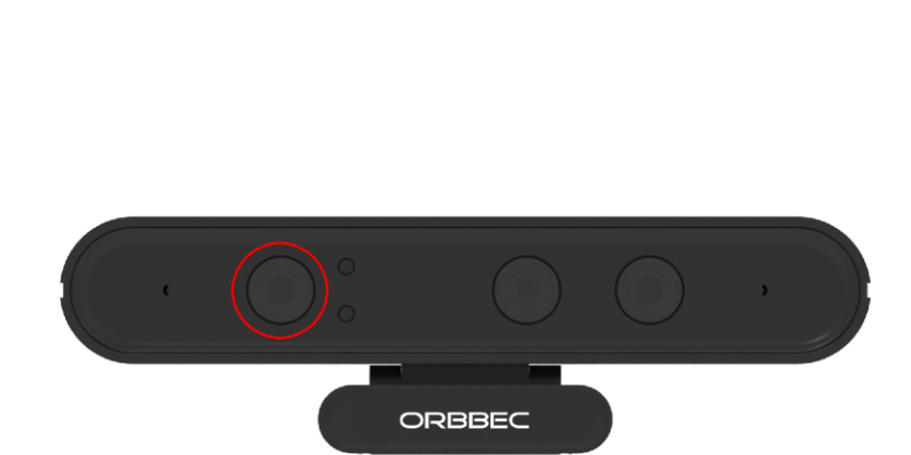
Slika 3.8 Orbbec Astra kamera s označenim projektorom
