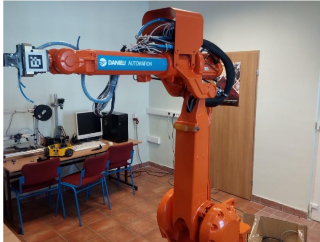
Slika 5.1. Robotski manipulator IRB 2400L
