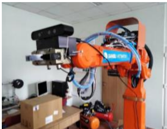
Slika 5.4. RGB-D kamera postavljena na hvataljku manipulatora
