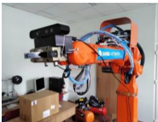
Slika 5.4. RGB-D kamera postavljena na hvataljku manipulatora
