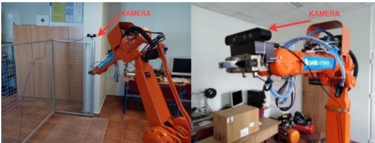
Slika 2.10. Pozicije kamere za vizualni servoing
