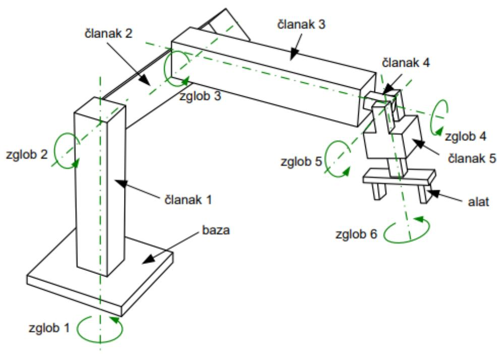
Slika 2.1. Robotski manipulator [1]
