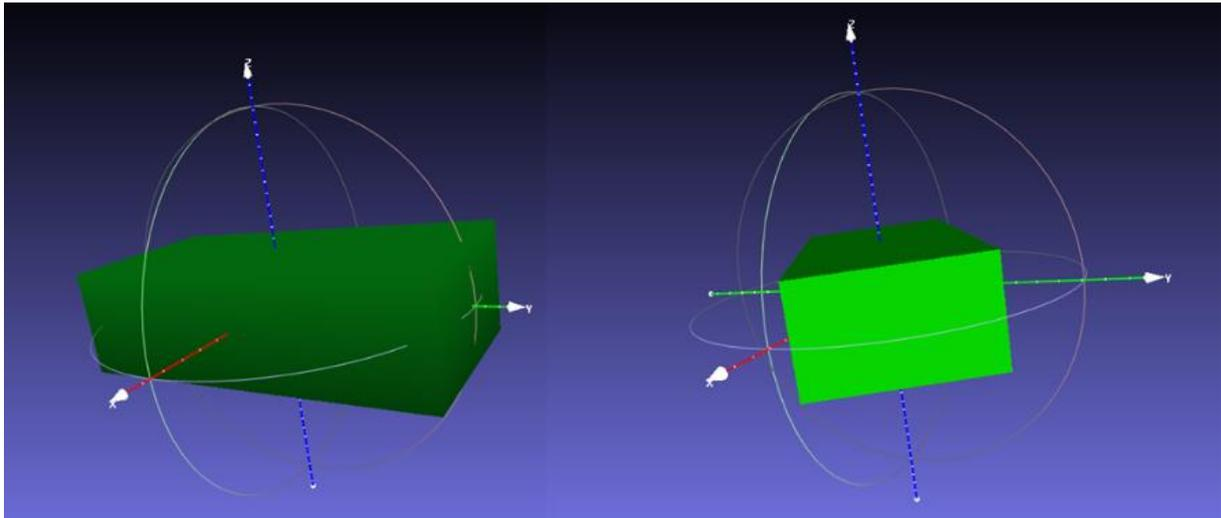
Slika 2.3. Rotacija predmeta oko z osi za 30 stupnjeva
