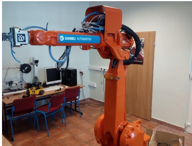
Slika 5.1. Robotski manipulator IRB 2400L
