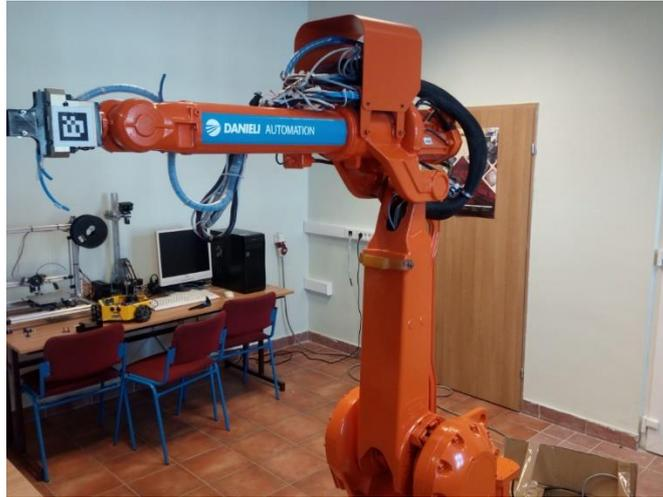
Slika 5.1. Robotski manipulator IRB 2400L
