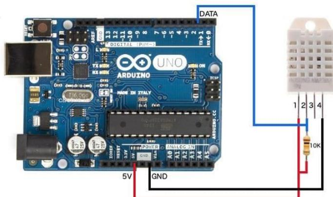
S1.4.1. Primjer spajanja DHT22 senzora [17]
