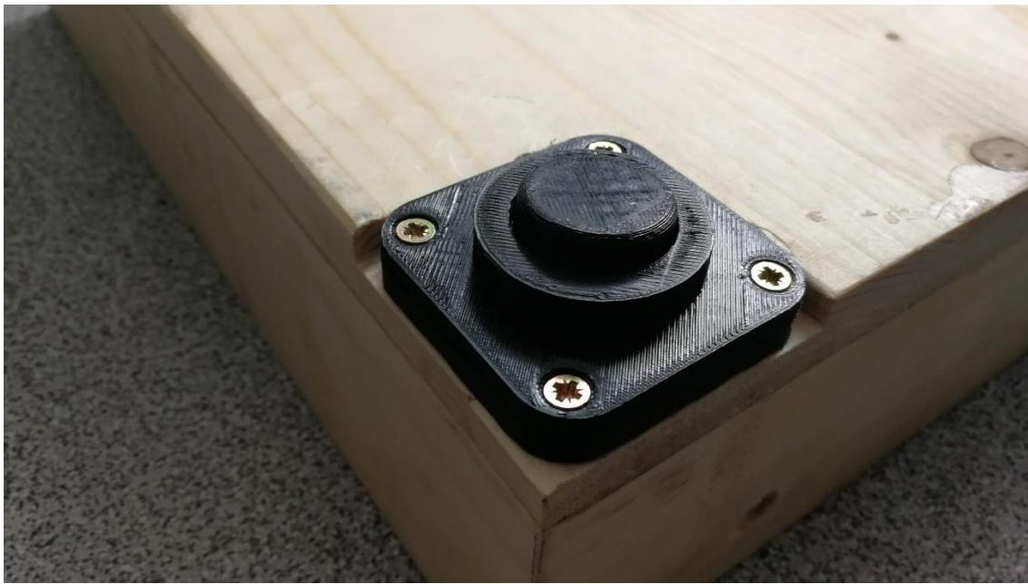
S1.5.2. Kućište za senzore mase
