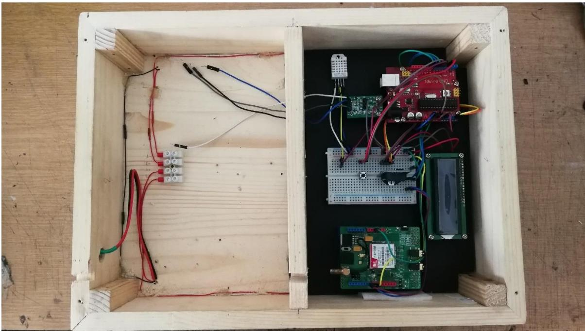
S1.5.4. Kućište vage s glavnim komponentama
