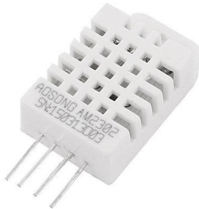
Sl.3.2 DHT22 senzor temperature i vlage zraka [6]
