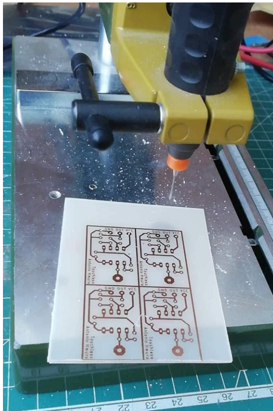
Sl. 4.11. Fotografija dijela procesa izrade pločice
