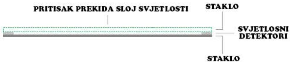
Sl. 3.3. Primjer presjeka infracrvenog zaslona osjetljivog na dodir [5].
