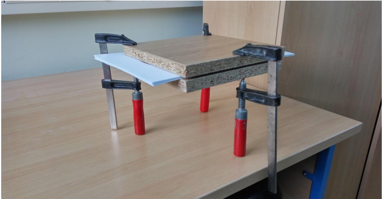
Slika 17. Stabilizacija pločastog kondenzatora drvenim oblogama i stegom
