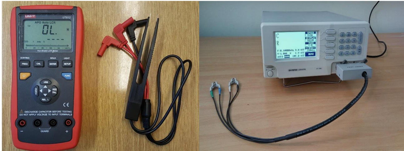
Slika 18. a) Unit 612 LCR, b) GW Instek 816 LCR
