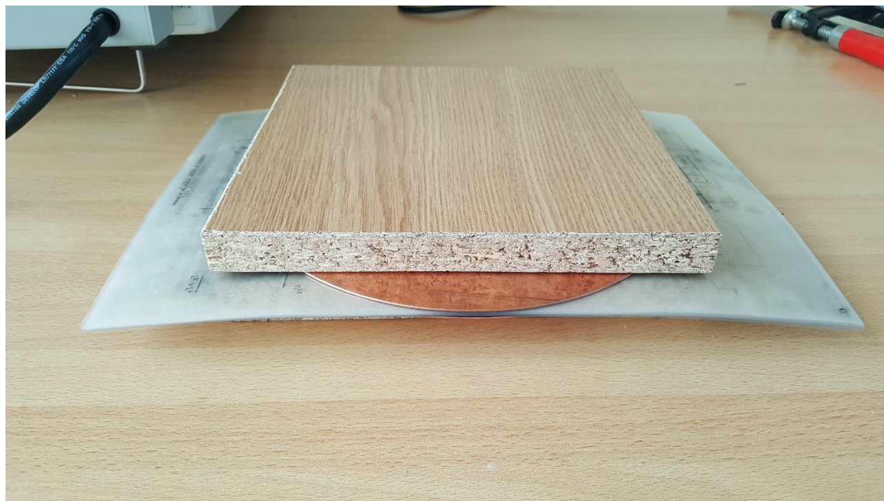
Slika 16. Prikaz pločastog kondenzatora sa folijom od termoplastičnog polimera
