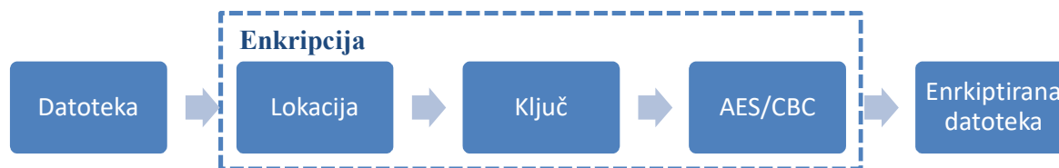
SI.3.2. Dijagram tijeka kriptiranja datoteke pomoću lokacije.
