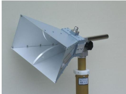
**Slika 2.1. Pravokutna lijevak antena [7]**
