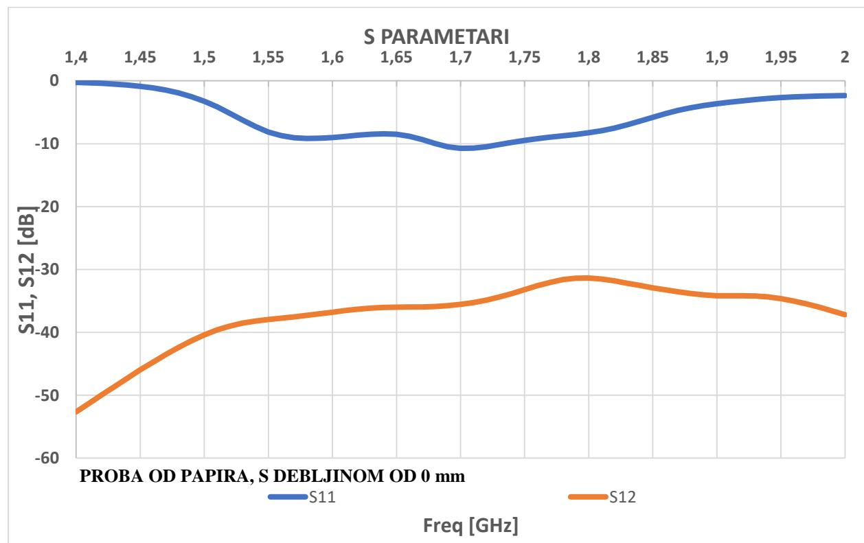
**Slika 5.2.**  $S_{11}$  i  $S_{12}$  parametar bez dielektričnog plašta
