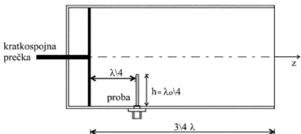
**Slika 2.7.** Geometrija i dimenzije pri pobudi TE<sub>11</sub> moda kružnog valovoda;  $\lambda$  označava valnu duljinu vala unutar valovoda;  $\lambda_0$  valnu duljinu vala u slobodnom prostoru [8]
