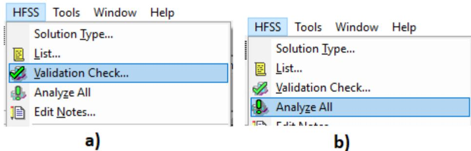
**Slika 4.48.** a) Provjera ispravnosti modela; b) Pokretanje simulacije
