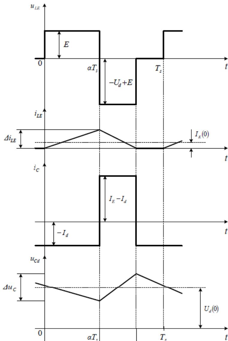
Slika 3.4. Valni oblici diskontinuiranog režima rada [3]
