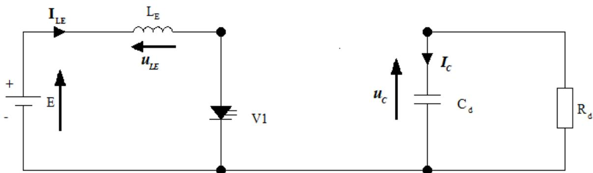
Slika 3.1. Shema spoja za kontinuirani režim rada u intervalu  $\langle 0, \alpha T_s \rangle$
