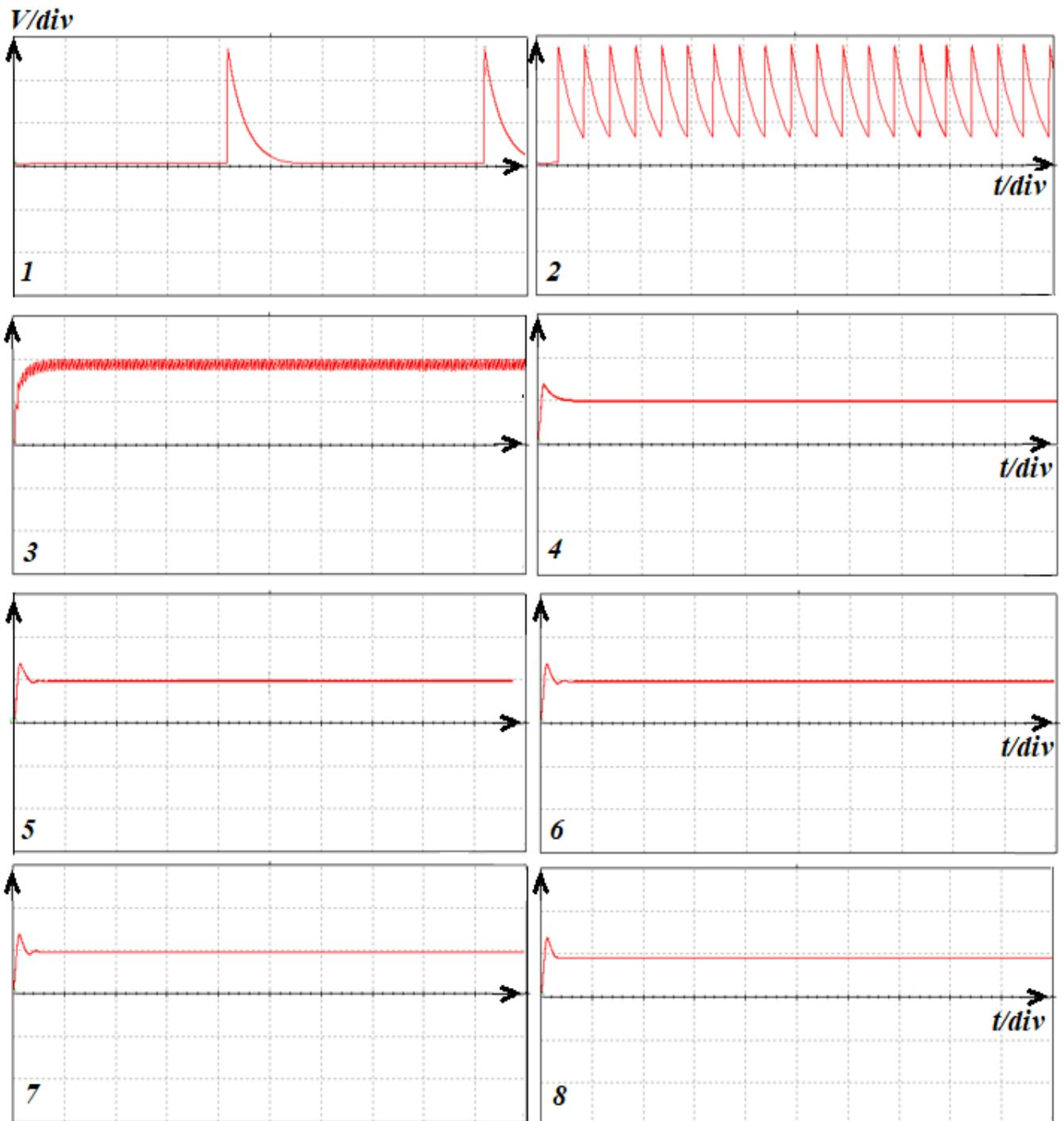
Slika 6.3. Grafički prikaz izlaznog napona za različite sklopne frekvencije  $f_s$ , gdje je podjela napona 5 V/podjeljku, a vrijeme 20 ms/podjeljku
