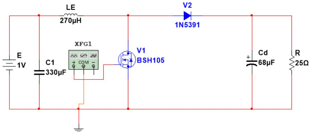
Slika 5. 3 Shematski prikaz modela uzlaznog pretvarača
