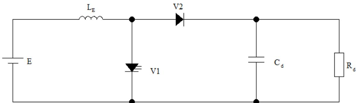
Slika 2.1. Shematski prikaz uzlaznog pretvarača
