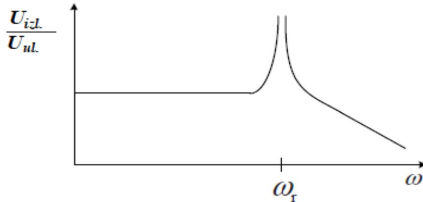
Slika 6.2. Ovisnost omjera izlaznog i ulaznog napona o promjeni frekvencije
