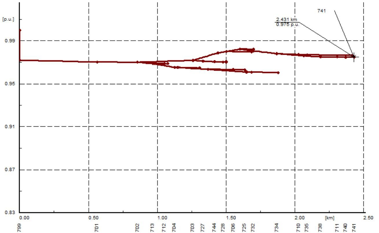
**Slika 5.5.:** Profil napona nakon integracije DG jedinice
