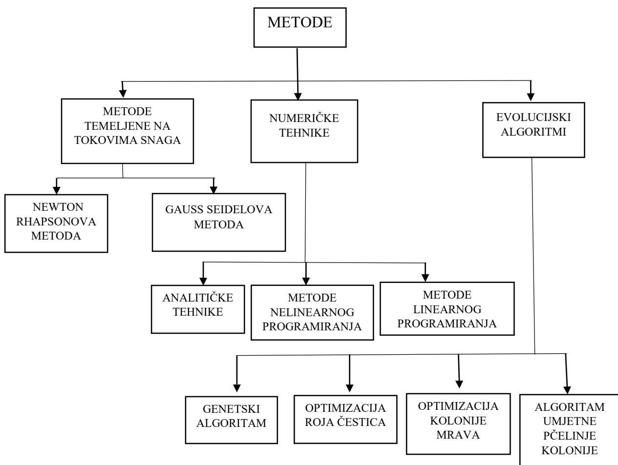
Slika 3.1.: Metode za određivanje optimalne lokacije i dimenzijske DG jedinice [1]
